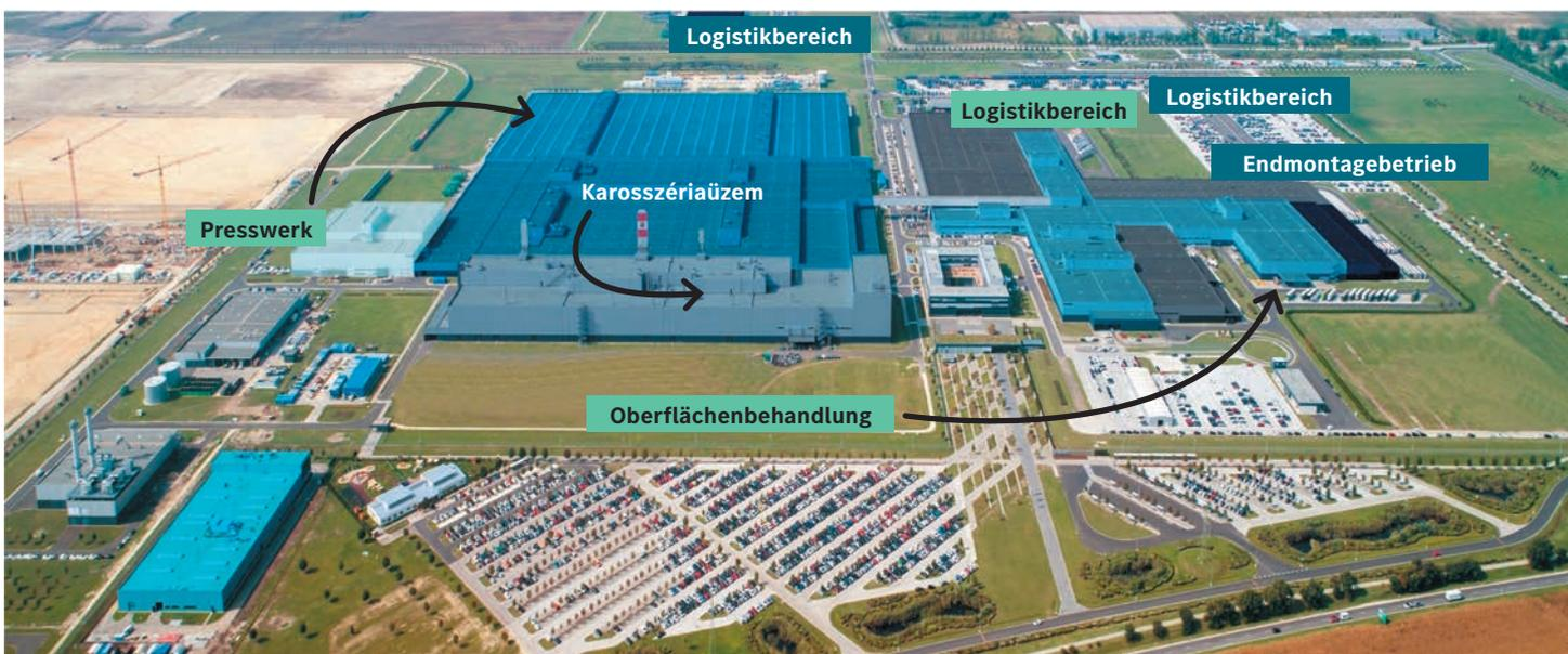
Abbildung 2: Die Lage der Produktionseinheiten
