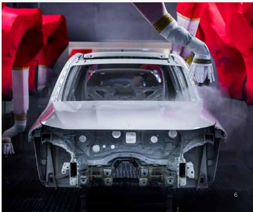
Im zweiten Behandlungsschritt erfolgt die Auftragung der Deckschicht auf die Karosserie, wobei diese Schichtauftragung zwei technologisch ähnliche, jedoch unterschiedlich anzusehende Phasen umfasst:
