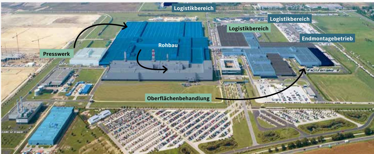
Bild 2: Produktionseinheiten
