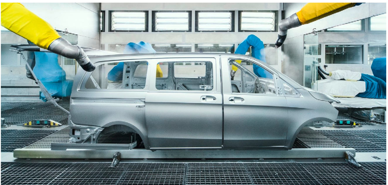
Cabina de Pintura
