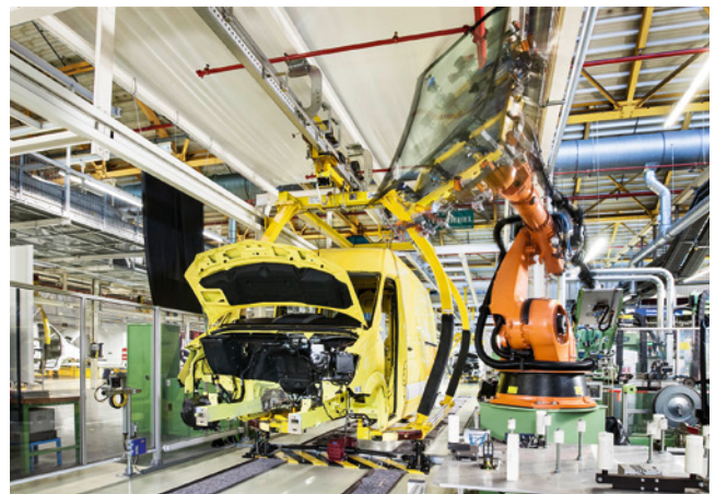
Scheibenzentrum in der Montage
