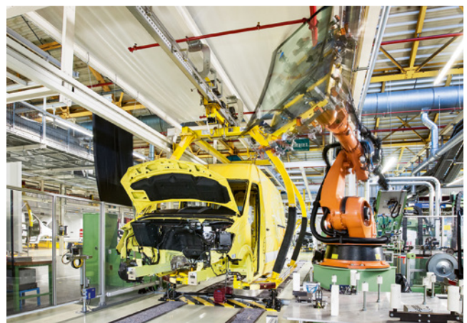
Scheibenzentrum in der Montage
