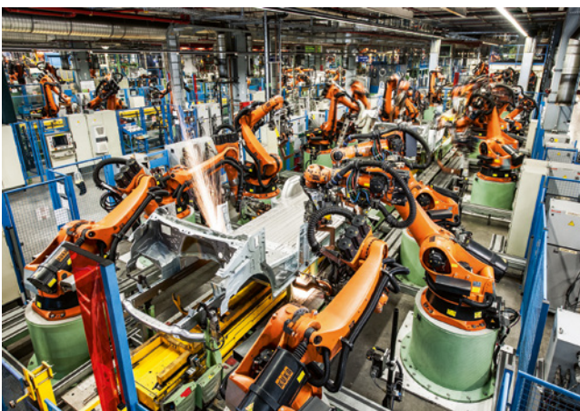
Roboter im Rohbau
