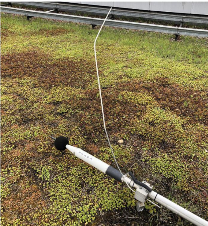
Die Schallimmissionen für die Auf- bzw. Immissionspunkte werden durch ein kontinuierlich arbeitendes Messnetzwerk aus Umweltmikrofonen auf hoch gelegenen Punkten im Außenbereich z. B. Gebäudedächern innerhalb des Produktionsstandortes erfasst.
