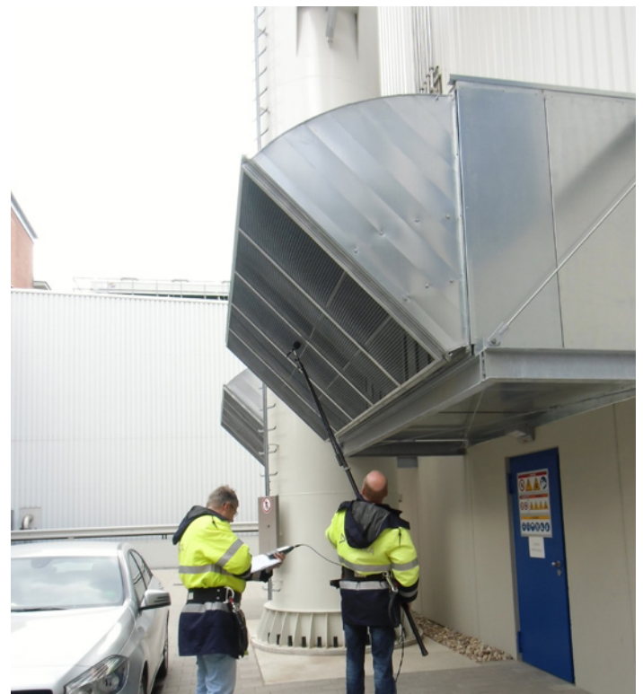
Schallschutzmessung am BHKW.
