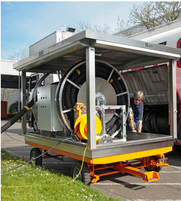
Betankung von Kühlschmierstoffen über doppelwandige Schlauchleitung.
