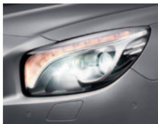
(ILS) bestückt. Mit fünf verschiedenen Lichtfunktionen, die auf typische Fahr- und Wettersituationen abgestimmt sind und sich je nach Fahrsituation einschalten, bieten sie dem Autofahrer ein deutlich besser ausgeleuchtetes Sichtfeld.
