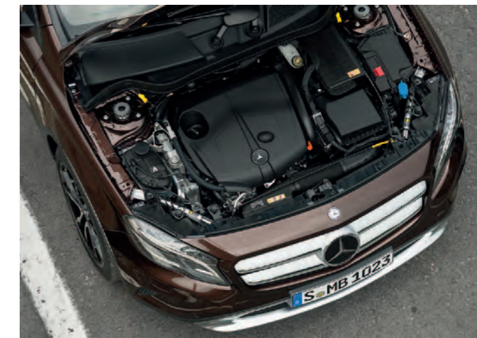
Dynamischer Durchzug gepaart mit höchster Effizienz zeichnet ebenso die beiden Diesellaggregate aus: Der GLA 200 CDI leistet 100 kW (136 PS), hat einen Hubraum von 2,2 Litern sowie ein maximales Drehmoment von 300 Nm. Der GLA 220 CDI verfügt ebenfalls über 2,2 Liter Hubraum und leistet 125 kW (170 PS) sowie 350 Nm.
