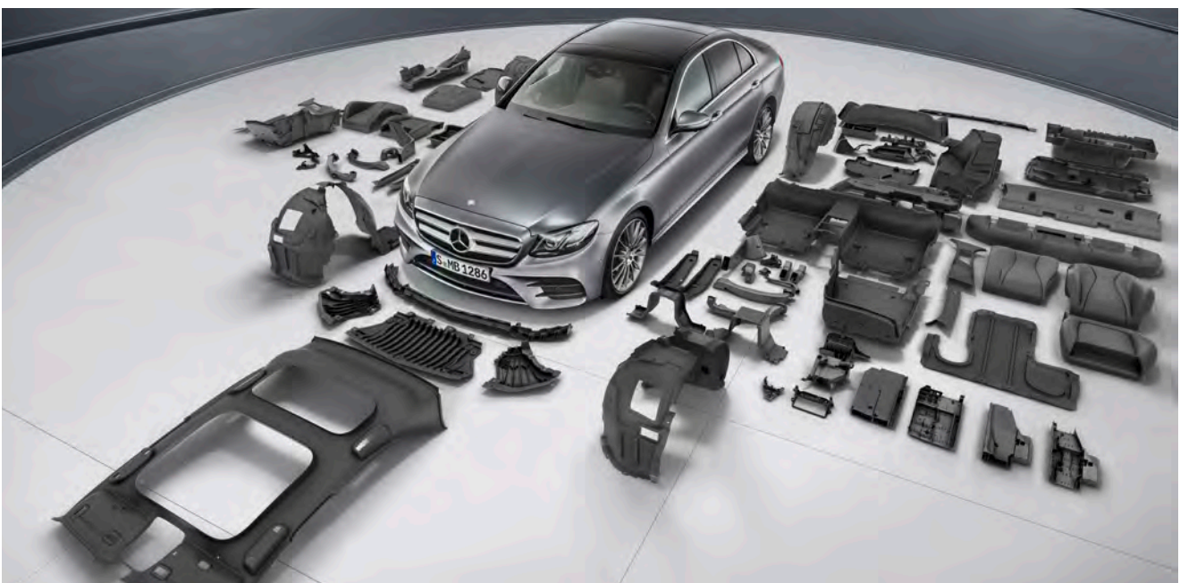
Abbildung 3 2: Rezyklateinsatz in der E-Klasse Limousine
