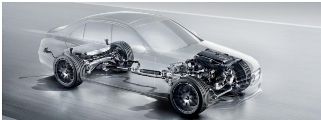
Die Plug-In Hybrid-Technik kann ohne Änderung der Fahrzeugstruktur in die C-Klasse integriert werden, denn das Hybridgetriebe der zweiten Generation basiert auf dem Automatikgetriebe 7G-TRONIC PLUS. Trotz des Platzbedarfs des Akkus bietet der C 350 e in der Limousine ein Kofferraumvolumen von 335 Liter.
