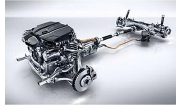
bestem Emissionsverhalten. Um dieses Ziel zu erreichen, transferierte Mercedes-Benz die BlueDIRECT Technologie aus den V6- und V8-Motoren in den Vierzylinder. Das Direkteinspritzsystem mit strahlgeführter Verbrennung, das Mercedes-Benz als erster Pkw-Hersteller in der Serie angeboten hat, arbeitet mit einer elektronisch präzise gesteuerten Mehrfacheinspritzung.
