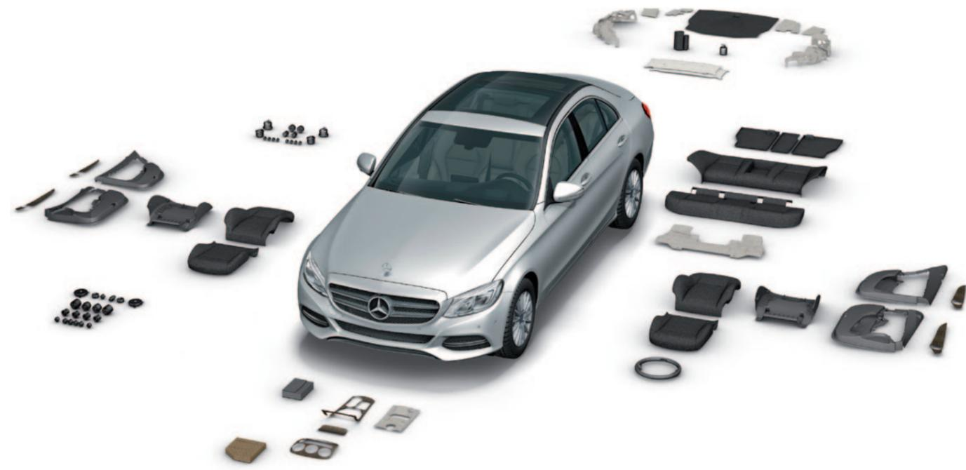
Abbildung 2-16: Bauteile aus nachwachsenden Rohstoffen in der neuen C-Klasse.
