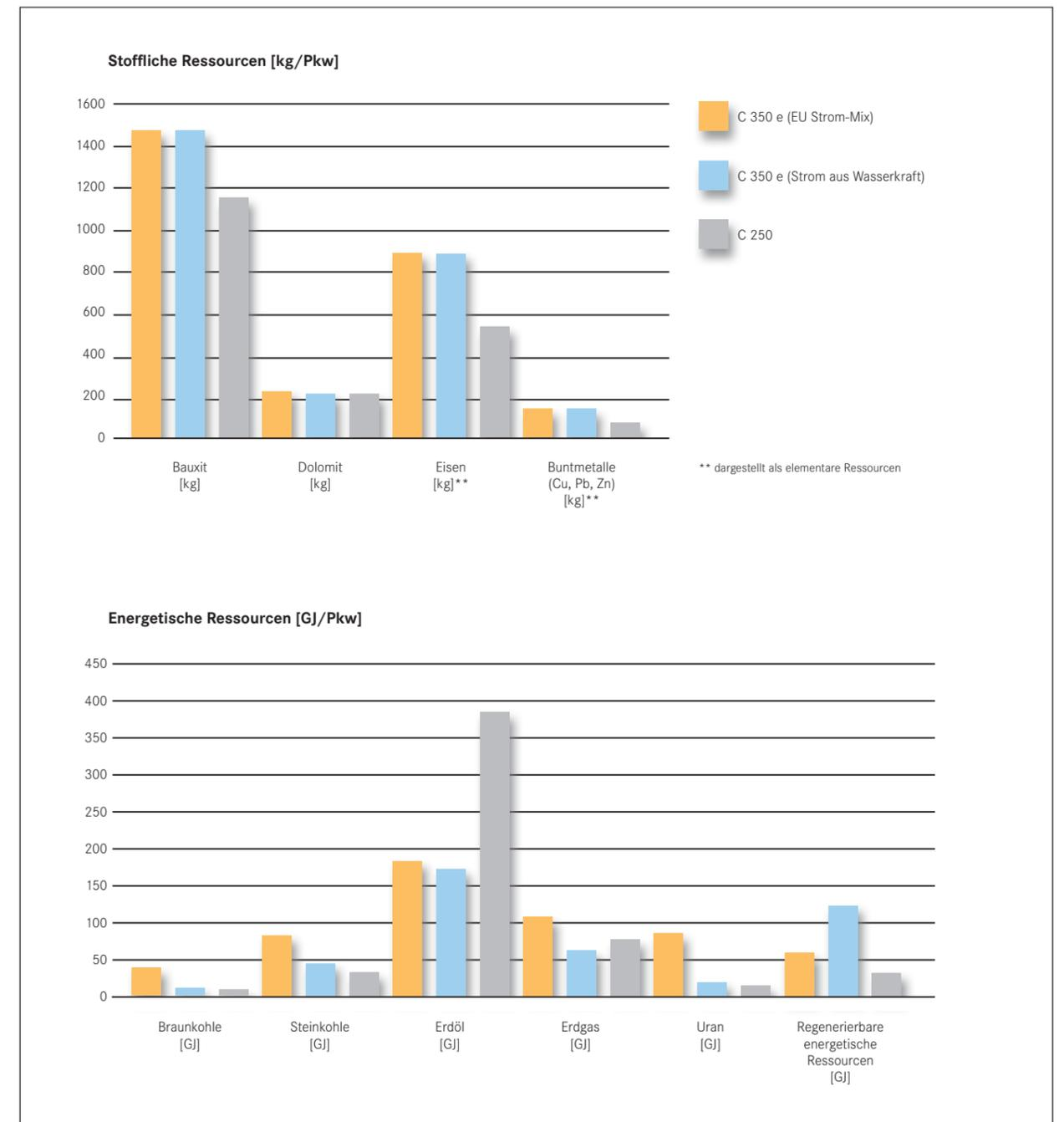
Abbildung 2-12: Verbrauch an ausgewählten stofflichen und energetischen Ressourcen C 350 e im Vergleich zum C 250 [Einheit/Pkw]
