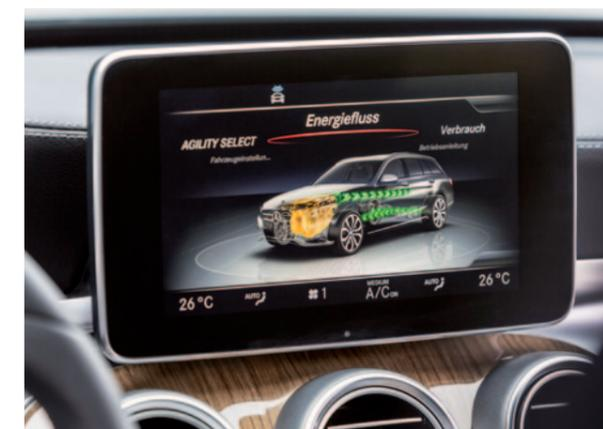
Das intelligente Antriebsmanagement des C 350 e wählt im Hintergrund automatisch die ideale Kombination aus Verbrennungsmotor und E-Maschine. Hinzu kommen innovative Funktionen wie streckenbasierte Betriebsstrategie oder haptisches Fahrpedal, die den Fahrer auf Wunsch beim sparsamen Fahren unterstützen.
