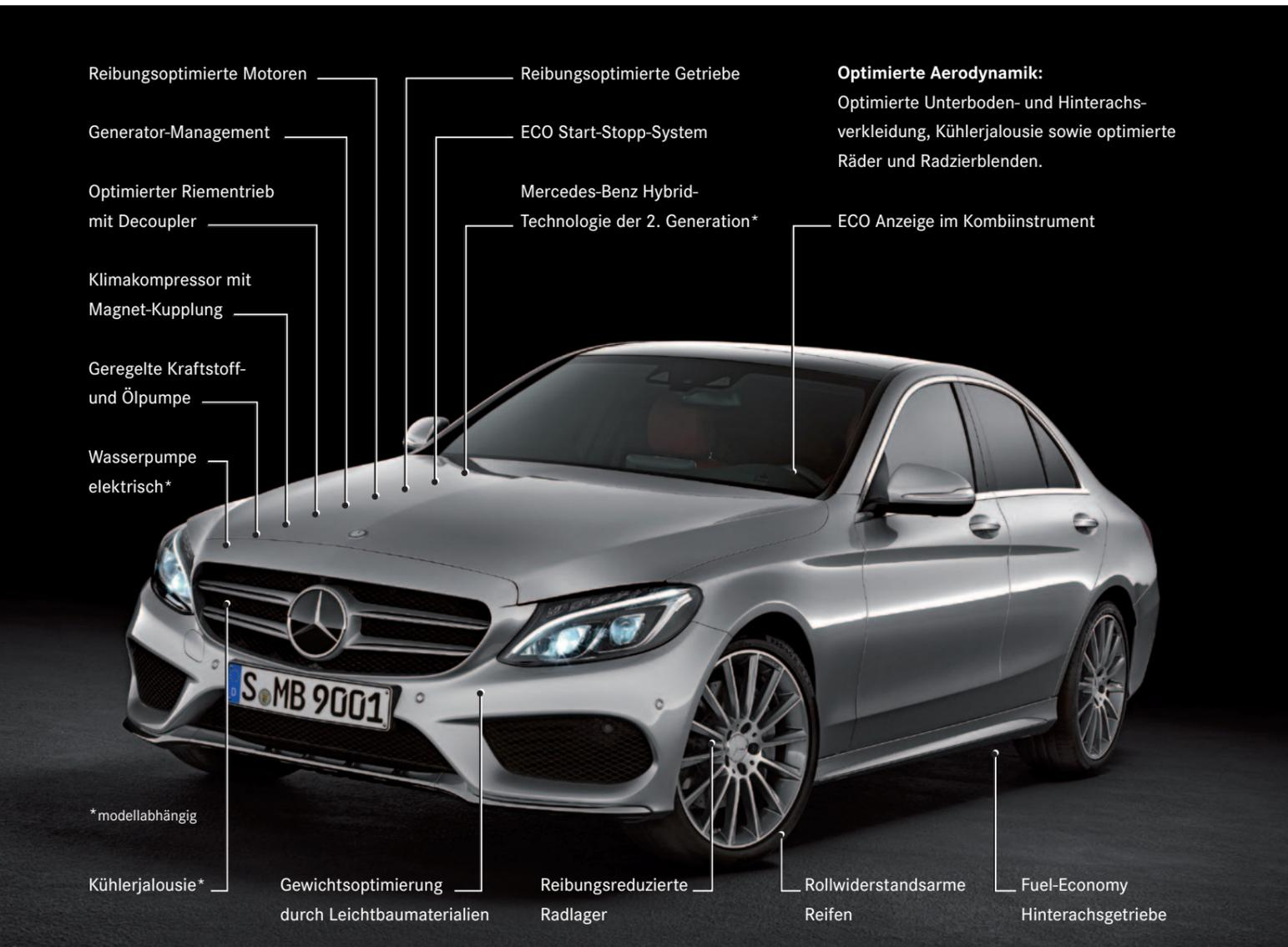
Abbildung 2-1: Verbrauchsreduzierende Maßnahmen in der neuen C-Klasse
