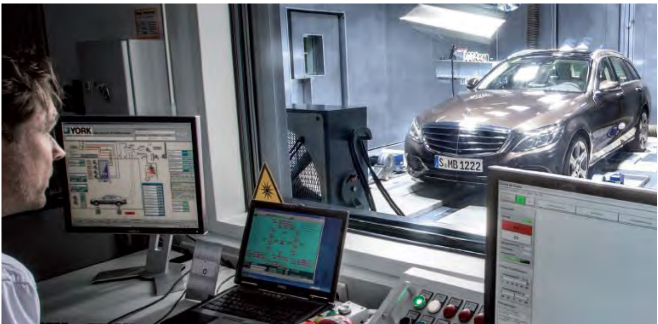
Abbildung 3-1: Prüfkammer zur Messung von Innenraumemissionen
