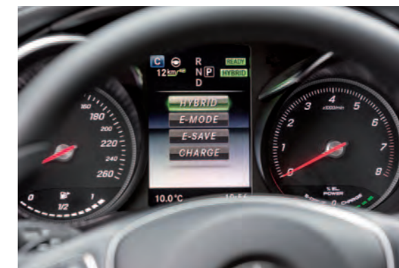
In Kombination mit COMAND Online ist eine streckenbasierte Betriebsstrategie möglich. Manuell stehen fünf Fahrprogramme und vier Betriebsarten (links) zur Wahl
