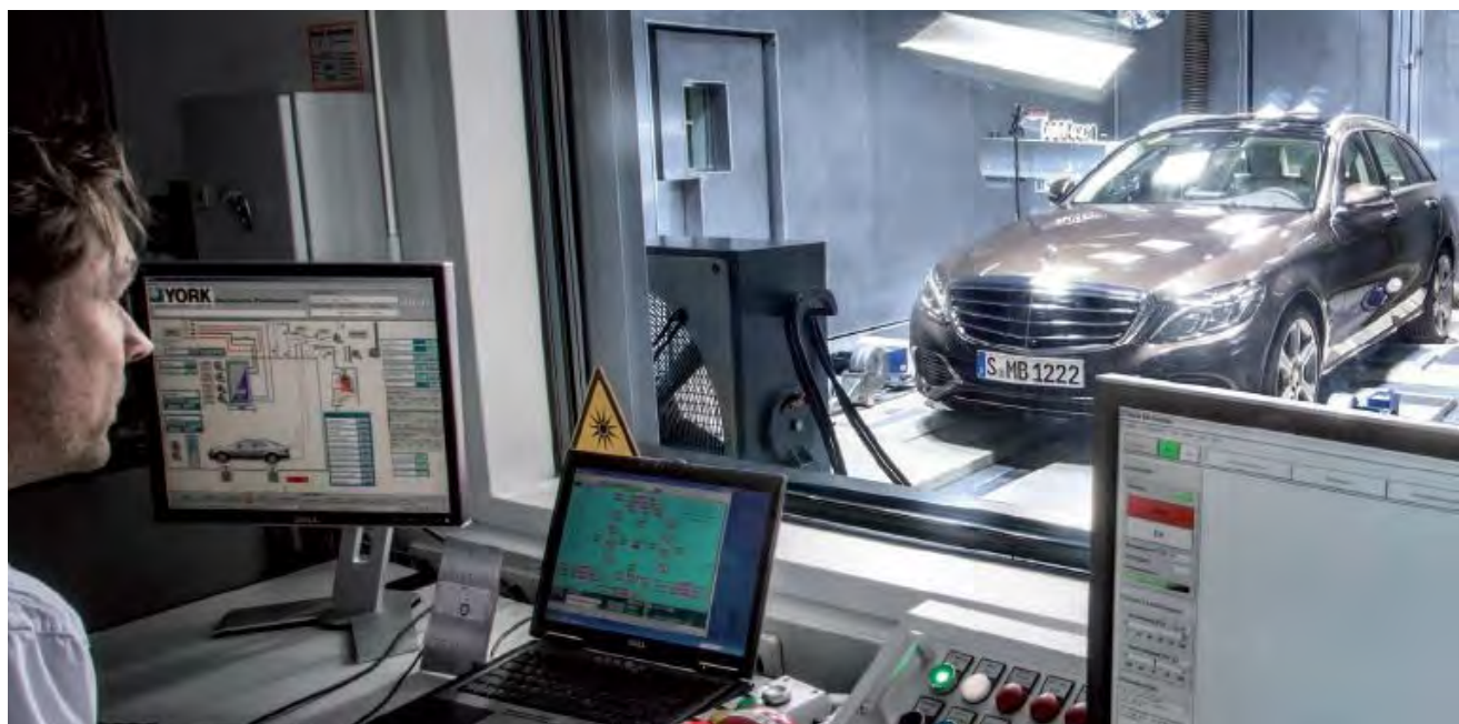
Abbildung 3-1: Prüfkammer zur Messung von Innenraumemissionen
