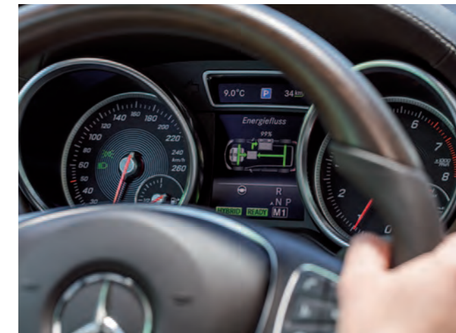
Gibt der Fahrer sein Ziel in das Navigationssystem ein, wählt die intelligente Betriebsstrategie für die Strecke die jeweils optimale Antriebskombination von Elektro- und Verbrennungsmotor.
