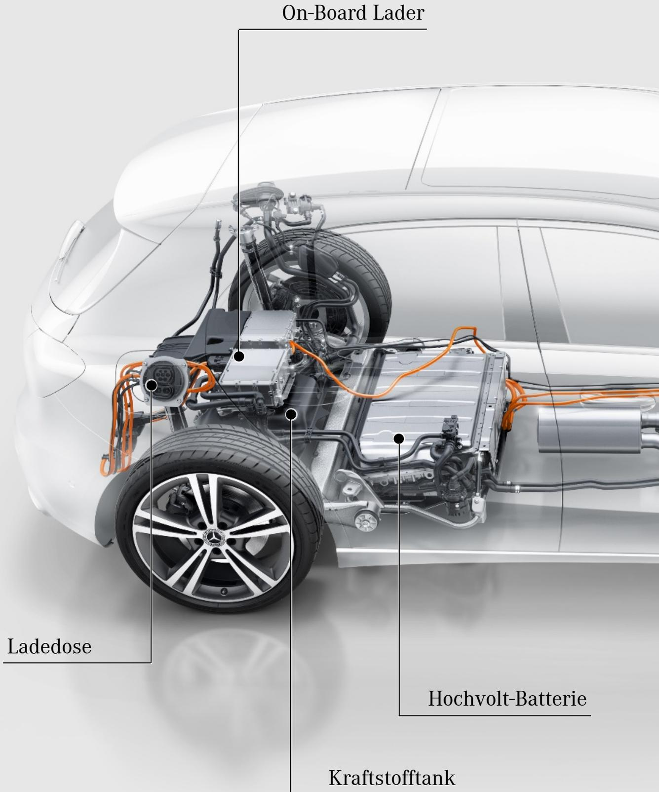
8F-DCT Getriebe mit Hybrid-
