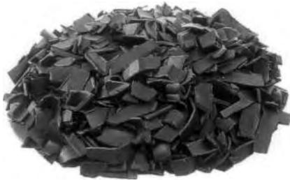
**Pkw-Stoßfänger aus lackiertem Polycarbonat werden für eine qualifizierte Verwertung zerkleinert. Durch die hochwertige Entlackung der Polycarbonatschnitzel entsteht ein Kunststoff, der zu hochwertigen Rezyklaten weiterverarbeitet wird.**
