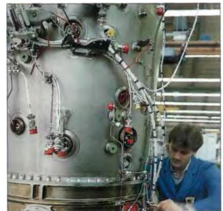
RB199 Triebwerke für den Tornado werden vertikal montiert. Hydraulisch versenkbare Bühnen erlauben ein Arbeiten in günstiger Arbeitshöhe.
