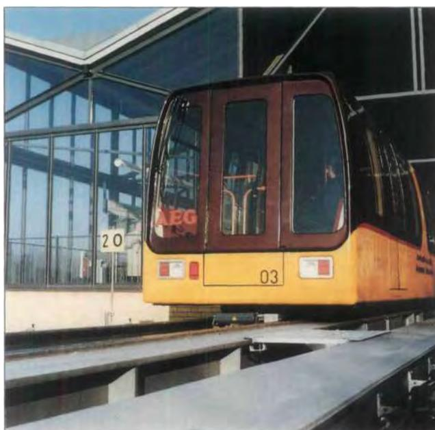
Die von AEG entwickelte M-Bahn ist ein vollautomatisches Nahverkehrssystem für mittlere Transportleistungen.
