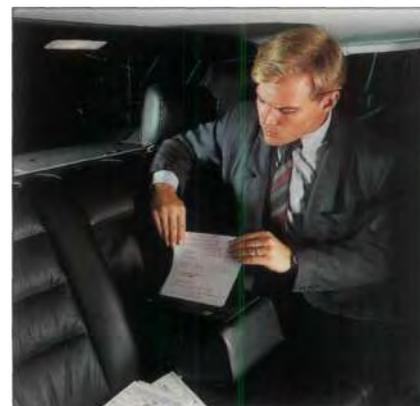
Mobiles Telefax-Kommunikationssystem Roadfax von AEG Olympia. Das portable Gerät ist über eine Adapterbox an das C-Funk-Autotelefon angeschlossen.
