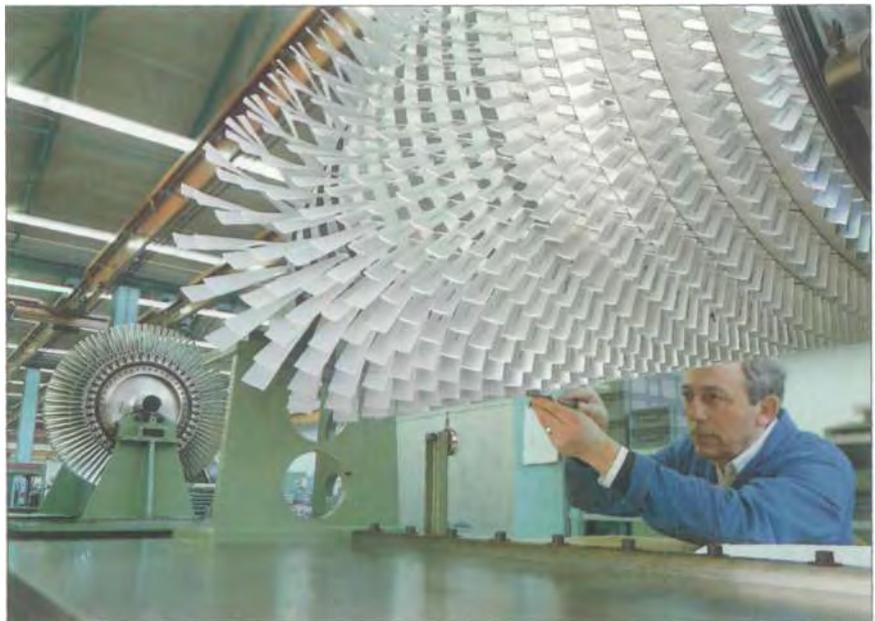
An einem 17stufigen Axialverdichterläufer eines Flugtriebwerks wird bei jeder Schaufel das Spitzenspiel gemessen und dokumentiert.
