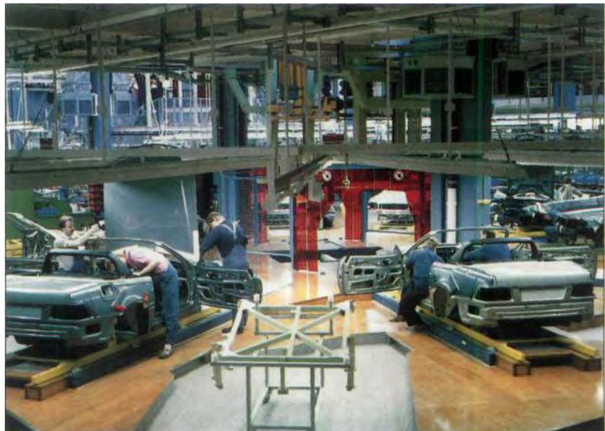
„Montagesterne“ für den neuen Roadster ermöglichen in Bremen den ergonomisch günstigen Einbau der Hydraulikleitungen, Kabelsätze und des Kaltverdeckes.
