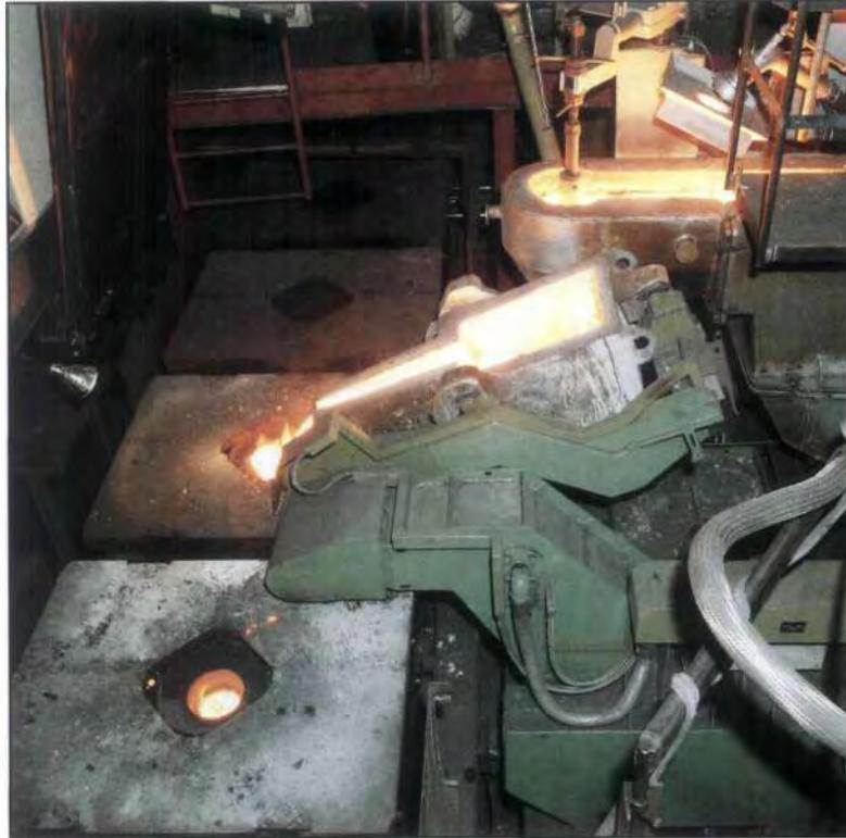
Vergießeinrichtung für Kugelgraphitguß an einer Formanlage im Werk Mannheim.
