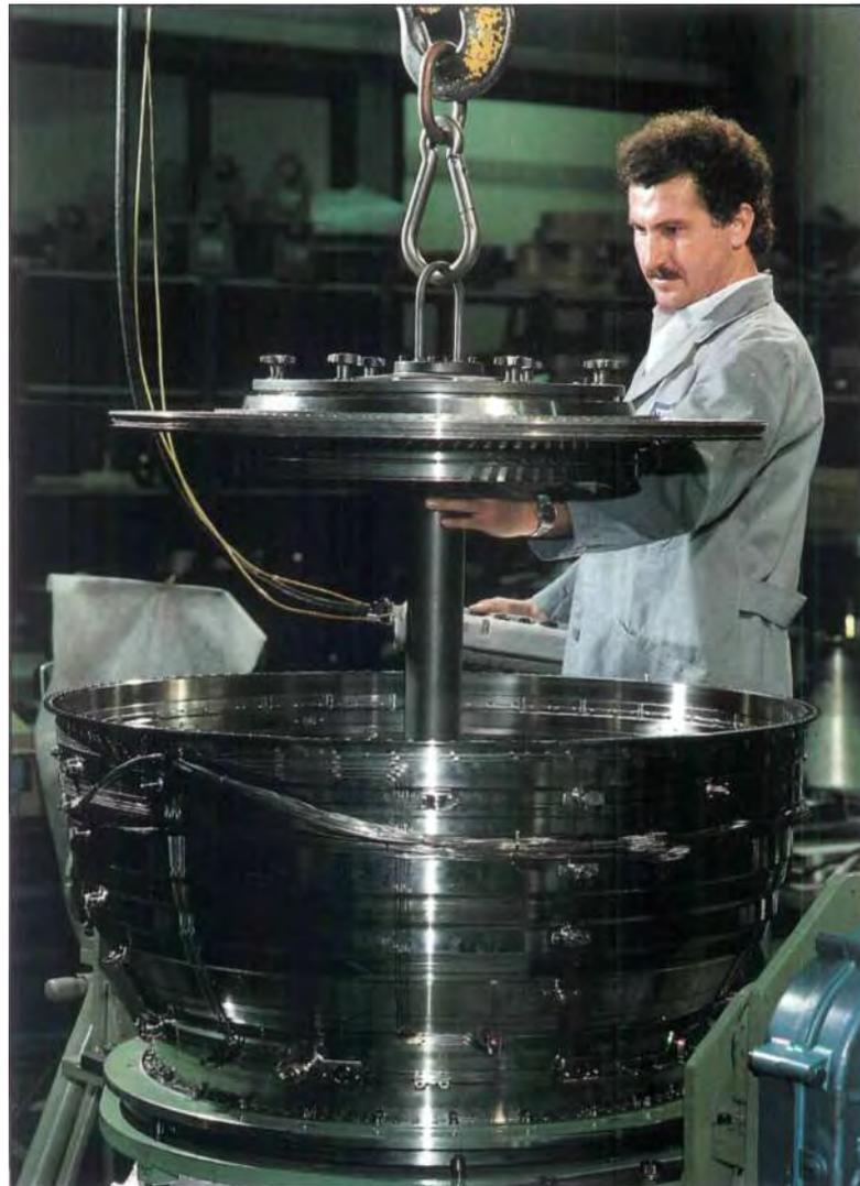
Montage einer Niederdruckturbinen der MTU für das Strahltriebwerk eines modernen Verkehrsflugzeugs.
