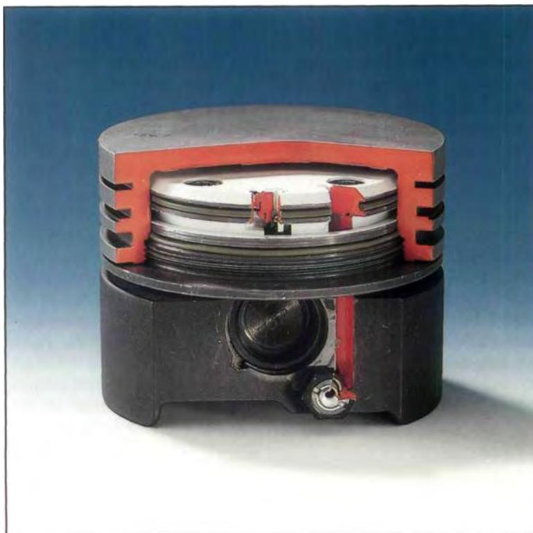
Zur Steigerung des Wirkungsgrads, insbesondere von Otto-Motoren, entwickelt Daimler-Benz gemeinsam mit der Mahle GmbH einen Kolben mit variabler Kompressionshöhe. Während des Betriebs wird die Kompressionshöhe automatisch so geregelt, daß der Motor stets mit optimalem Verdichtungsverhältnis arbeitet. Im Teillastbereich läßt sich dadurch der Kraftstoffverbrauch um bis zu 10% verringern.
