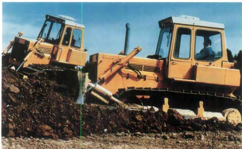
Baumaschinen verlangen besonders robuste Motoren. Hier im Bild: Planiertrauen mit hydrostatischem Antrieb bei Erdbewegungs-
