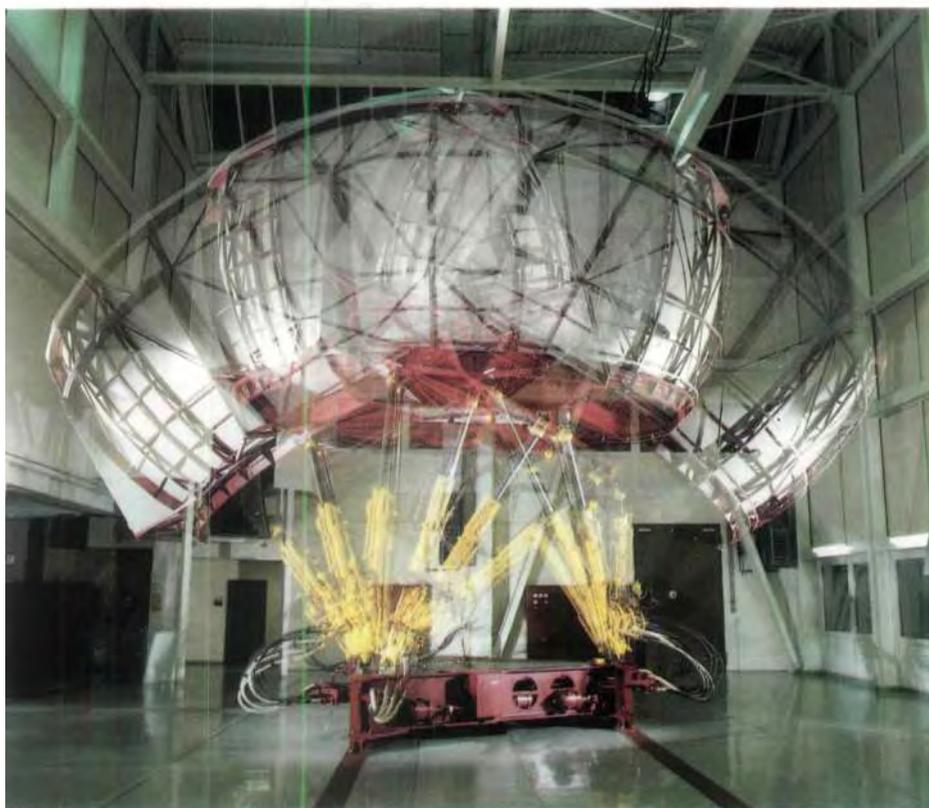
Der neue Fahrsimulator im Werk Berlin-Mariefelde: Mit Hilfe eines mathematischen Modells von einem Fahrzeug werden alle Bewegungen der Kabine von einem Rechner so gesteuert, daß der Fahrer den Eindruck
