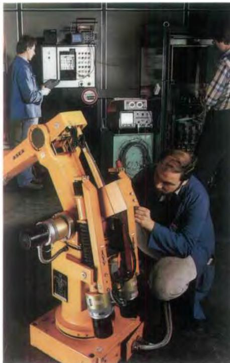
Auch hier geht es nicht ohne die Überwachungsfunktion des Menschen: Mitarbeiter bei der Instandsetzung von Industrierobotern.
