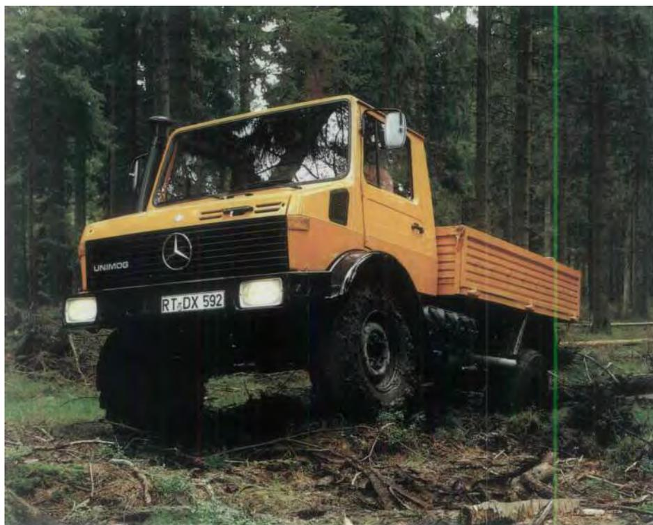
Unimog – allradgetriebene Zug- und Arbeitsmaschinen mit breitem Einsatzspektrum und hervorragender Geländegängigkeit.
