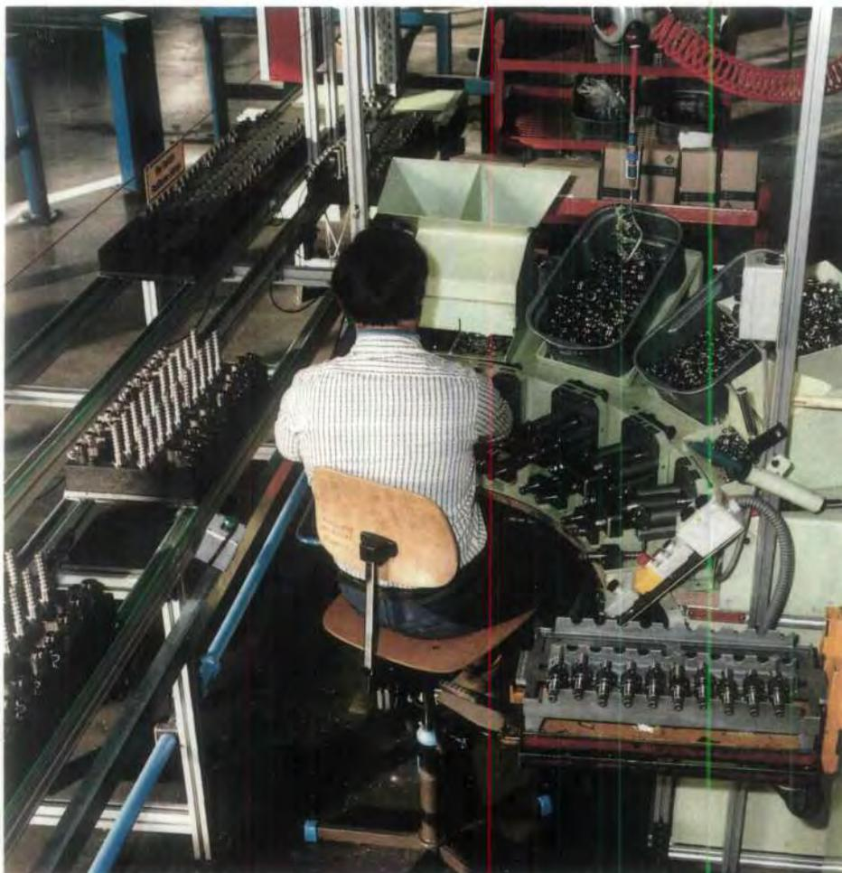
Im Werk Düsseldorf: Ein ergonomisch optimierter Montage-Arbeitsplatz in der Lenkungsmontage. Die kreisbogenförmige
