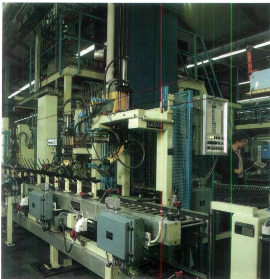
Automatische Fertigungslinie für Kopfstützen und Fügearbeitsgängen in unserem Werk Hamburg-Harburg mit Verkettung von Umform-, Schweiß-
