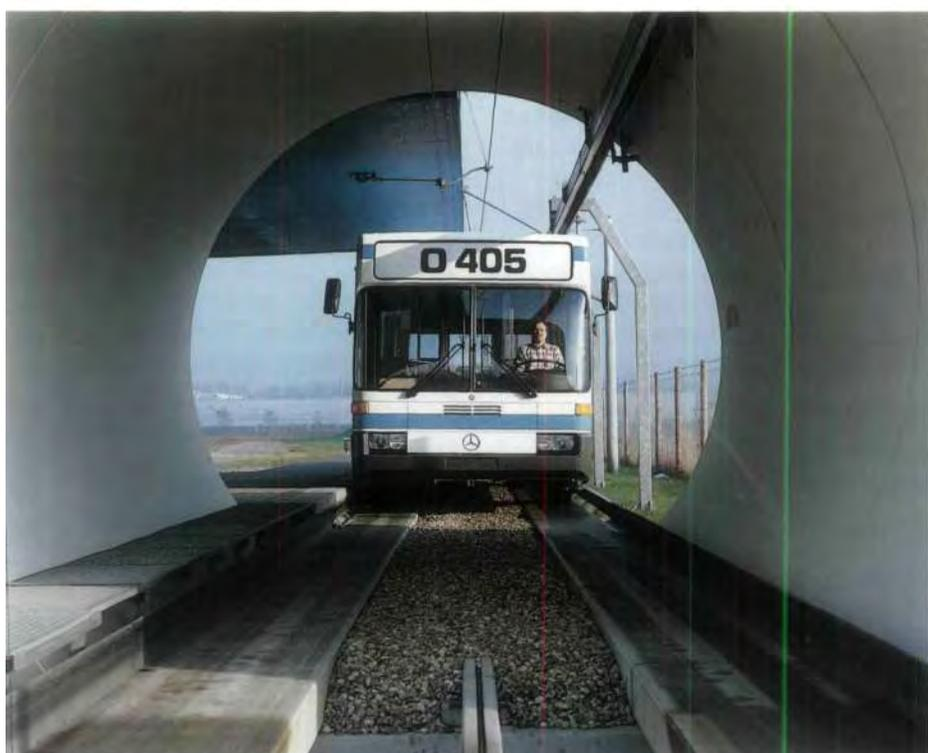
Der neue spurgeführte Linienomnibus O 405 auf der werkseigenen Versuchsbahn in
