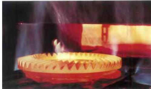
Beispiele für moderne Fertigungstechnologien im Werk Kassel: Einsatzhärten von Tellerrädern in einer Durchstoßanlage.
