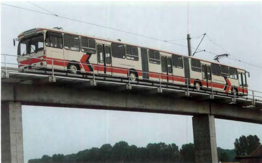
Großraumzug der Mercedes-Benz-O-Bahn mit Elektroantrieb und Oberleitung auf der Versuchsbahn in Rastatt.
