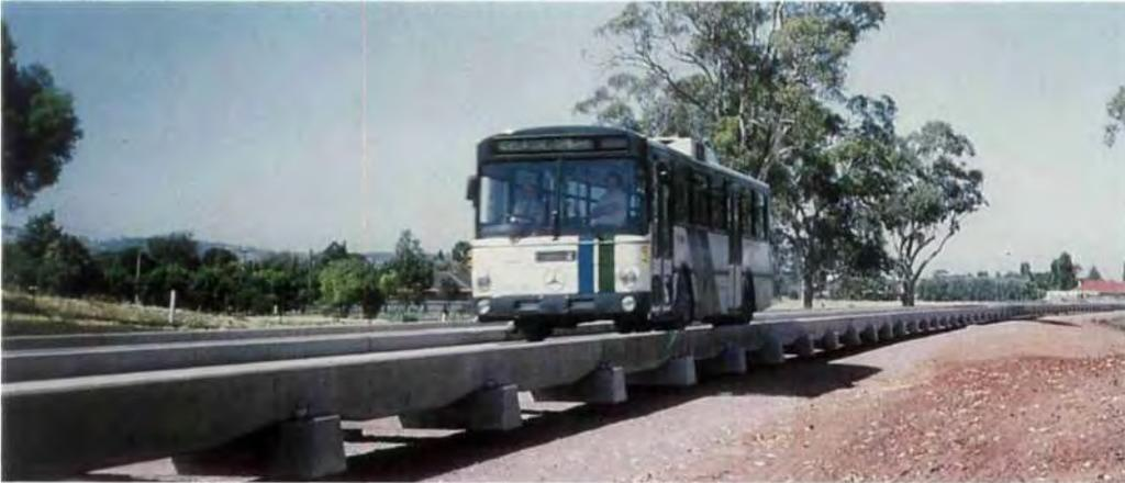
Das Mercedes-Benz-O-Bahn-System mit spurgeführten Bussen hat seine praktische Bewährungsprobe längst bestanden. Teilstück der 12 km langen O-Bahn-Strecke in Adelaide, Australien.
