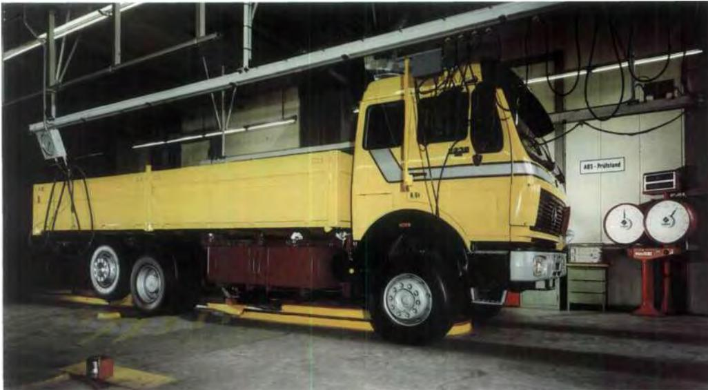
ABS Bremsprüfstand für Schwere Nutzfahrzeuge im Werk Würth.
