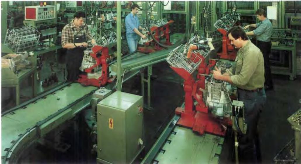
Bei der Fertigung des automatischen Getriebes im Werk Untertürkheim wird das Aggregat auf einem besonders entwickelten Werkstückträger mit Schwenkeinrichtung jeweils in eine Position gebracht, die eine günstige Körperhaltung bei der Arbeit ermöglicht.
