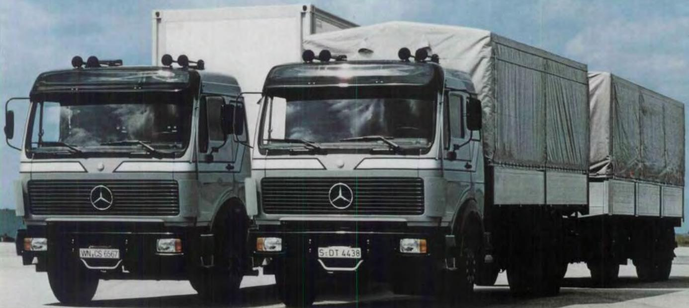
*Breiter, höher und komfortabler ist das Großraumfahrerhaus des „Flaggschiffs“ unter den Mercedes-Benz-Fernverkehrs-Lkw. Angeboten werden fünf Grundtypen mit dem neuen starken und sparsamen 276 kW/375 PS-Motor OM 422 LA (mit Abgasturbo-lader und Ladeluftkühlung).*
