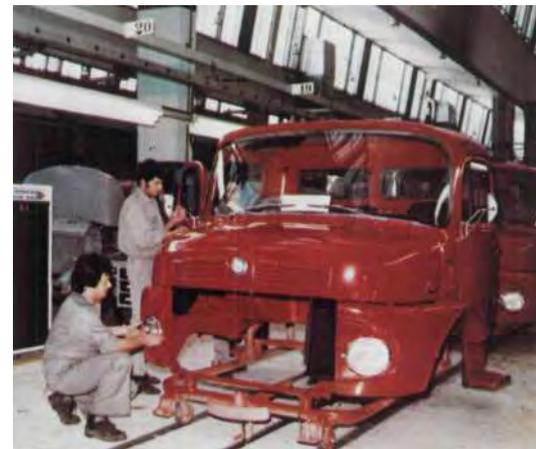
*Fahrerhausmontage im Nutzfahrzeugwerk der Mercedes-Benz Argentina S. A., Buenos Aires.*
