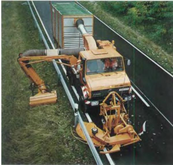
*Der Unimog U 1300 mit Böschungs- und Randstreifenmäher, ein vielseitiger Helfer für jeden Kommunalbetrieb.*
