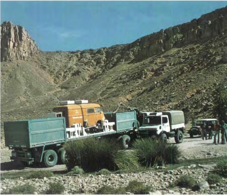
Sorgfältige Messungen der in der Praxis auftretenden Belastungen sind Grundlage für die Entwicklung qualitativ hochwertiger Fahrzeuge. Beim Befahren der Transsahara-Route mit einer Sattelzugmaschine werden die in einem Kastenwagen installierten Meß- und Registrier-einrichtungen auf dem Sattelaufleger mitgeführt.
