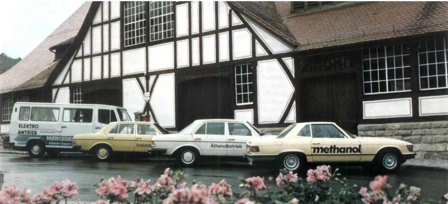
Alternativ-Antriebe in der Erprobung. Fahrzeuge mit Methanol-, Äthanol- und Elektroantrieb sowie mit Schichtladungsmotor. Ziel intensiver Forschungs- und Entwicklungsarbeit: mehr Umweltentlastung, weniger Kraftstoffverbrauch.
