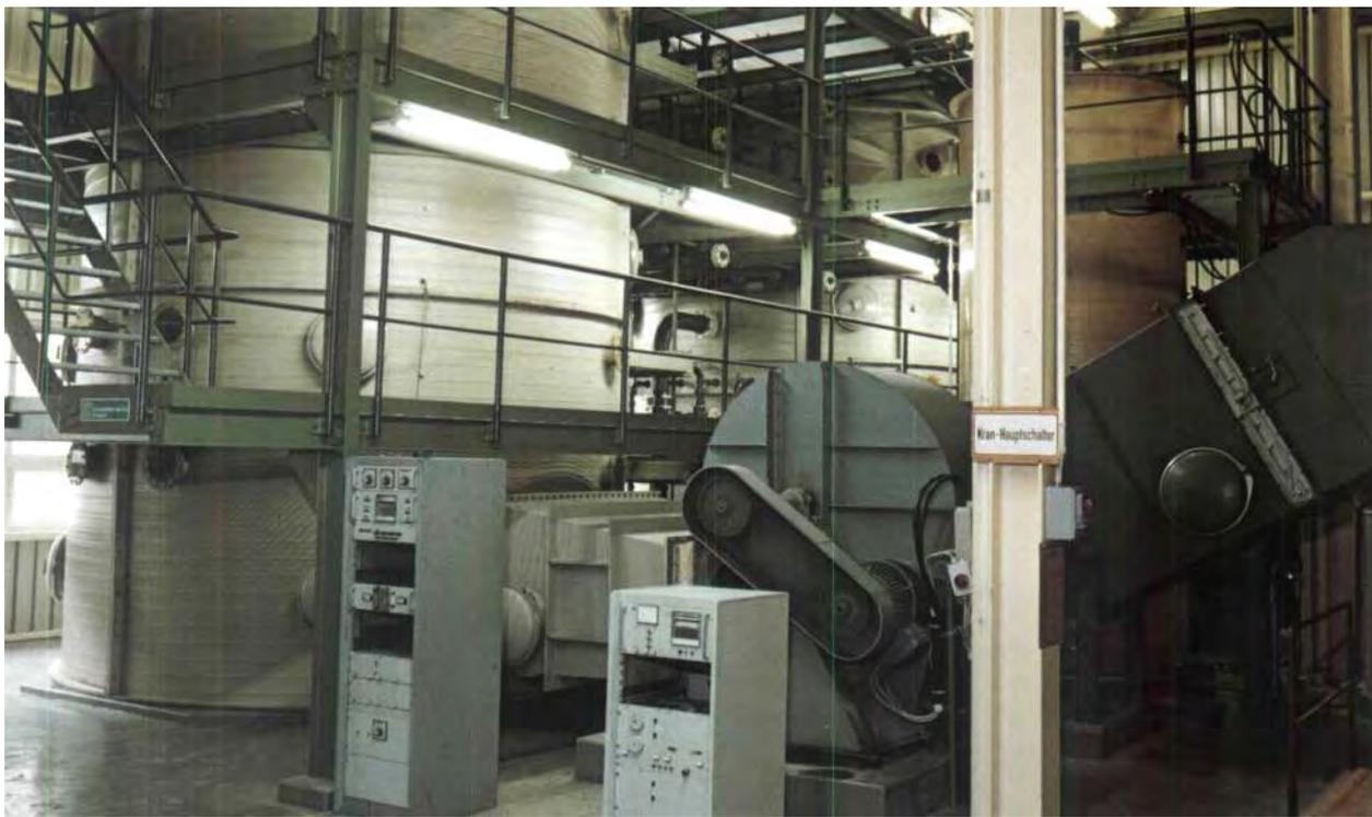
*Biologische Abluftaufbereitung im Werkteil Mettingen. Pro Stunde werden etwa 120 000 m<sup>3</sup> Gießerei-Abluft gereinigt. Auch das für die Reinigung benötigte Wasser wird mit Hilfe von Mikroorganismen wieder gesäubert und in den Kreislauf zurückgegeben.*
