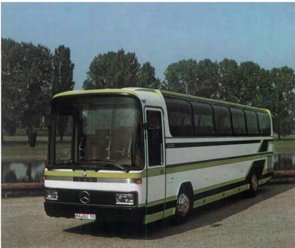
*Der O 303 RHD (Hoch-decker) ein neuer Mercedes-Benz-Fernreisebus. Durch den höheren Wagenboden wurde der Koffer-raum auf 12 m<sup>3</sup> vergrößert. Weitere Kennzeichen: mehr Sicherheit, mehr Komfort und stärkere Motoren.*
