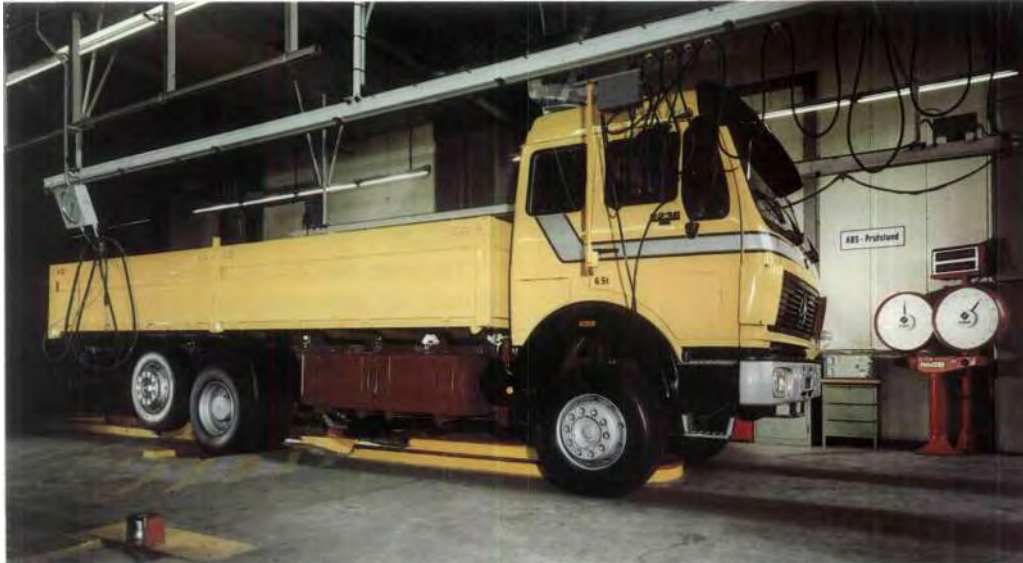
ALS (antiskid) brake-test stand for heavy-duty trucks in the Woerth plant.
