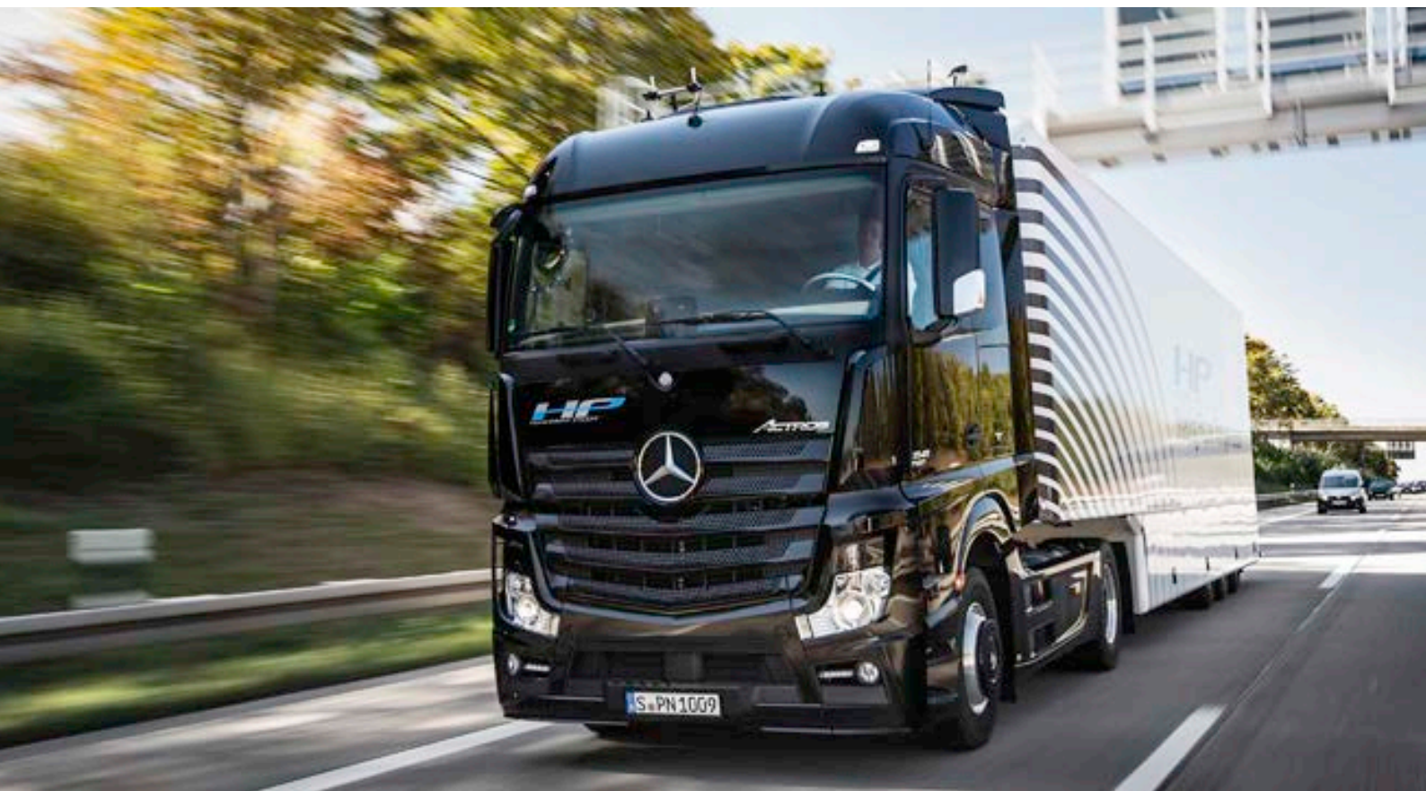
Mercedes-Benz Actros mit Highway Pilot: Premiere im Jahr 2015 für den ersten autonom fahrenden Serien-Lkw in Deutschland.
