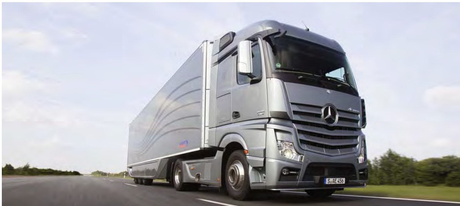
Der Aerodynamics Trailer spart im Jahr pro Sattelzug rund 2.000 Liter Diesel und entlastet die Umwelt um mehr als fünf Tonnen CO 2 -Emissionen.
