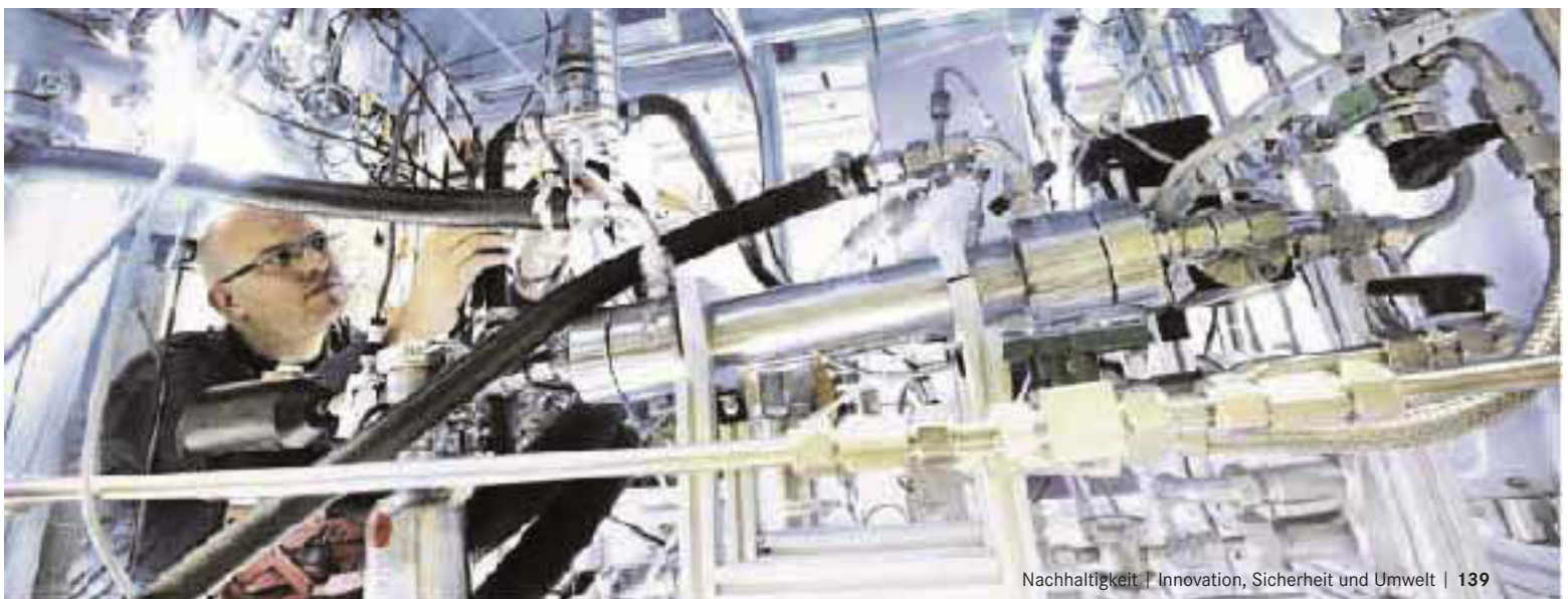
Prüfstand für Elektroantrieb mit Brennstoffzelle.
