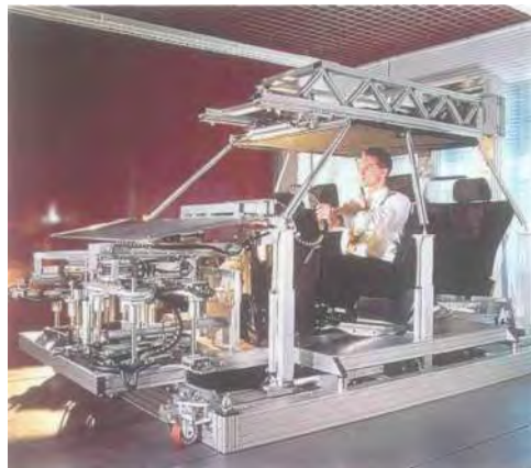
Mit dem neuen Ergonomieprüfstand erhalten die Fahrzeugentwickler wichtige Hinweise auf Kundenbedürfnisse.
