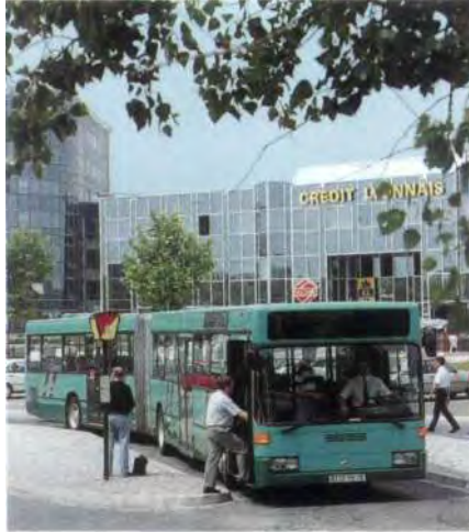
Rückgrat des Personennahverkehrs: Die Mannheimer Stadtbusfamilie O 405 in der Ausführung als Schubgelenkbus.
