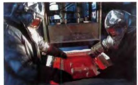
Bei 900 Grad Celsius verformen diese Werkstoff-Experten „superelastisch“ dünne Titanbleche. Nach Wunsch gestaltete Bauteile für die Luft- und Raumfahrt sind der Mühe Lohn.
