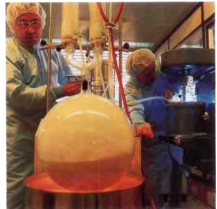
Im Rotationsverdampfer trocknet hier ein Siliziumnitrid Pulvergemisch – eine Vorstufe für gesinterte Keramikteile für den Automobilbau.
