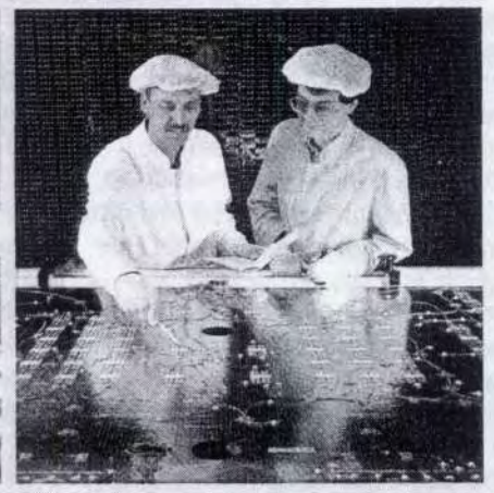
Verschaltung der Shuntdioden auf der Rückseite eines „Eureca“-Solarmoduls.
