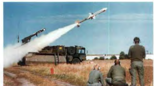
Dornier CL 289, ein Drohnensystem zur Lage- und Zielaufklärung.
