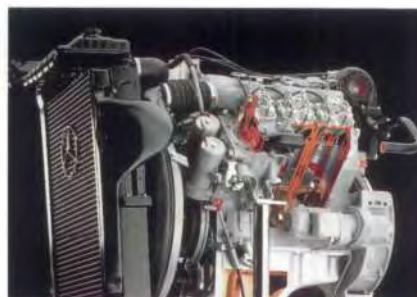
Kompakter V6-Motor OM 441 LA (249 kW) für Volumen-Lkw.
