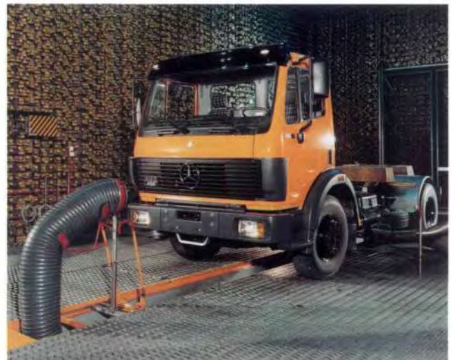
Ein Lkw aus unserer Wörther Produktion auf dem Rollenprüfstand zur Geräuschmessung. Eine wichtige Maßnahme zur weiteren Reduzierung der Geräuschentwicklung unserer Lkw.
