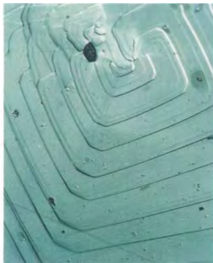
Wachstumsformen — beobachtet an Einkristallen von Hochtemperatur-Supraleitern zur Untersuchung von richtungsabhängigen Materialeigenschaften.
