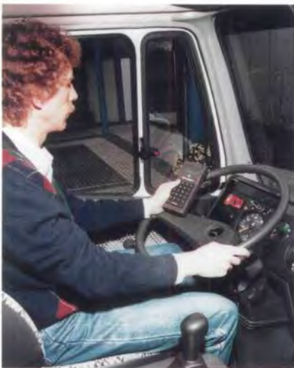
Ein Lkw aus unserer Wörther Produktion auf dem Rollenprüfstand zur Geräuschmessung. Eine wichtige Maßnahme zur weiteren Reduzierung der Geräuschentwicklung unserer Lkw.
