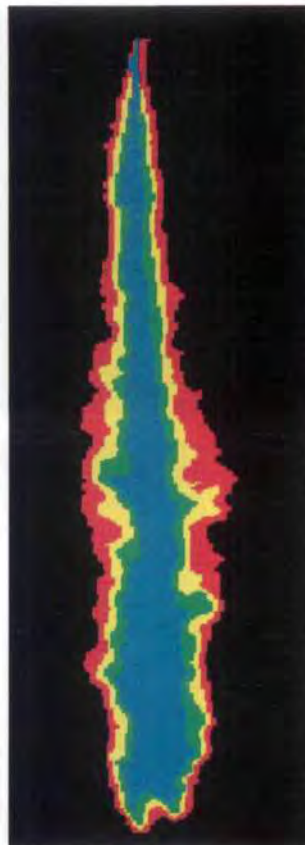
Elektronische Bildauswertung der Strahl-ausbreitung bei Diesel-Einspritzdüsen.
