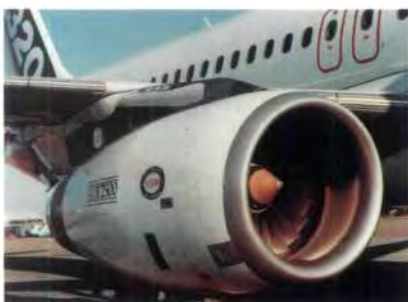
Das leistungsfähige Verkehrsflugzeugtriebwerk V 2500.
