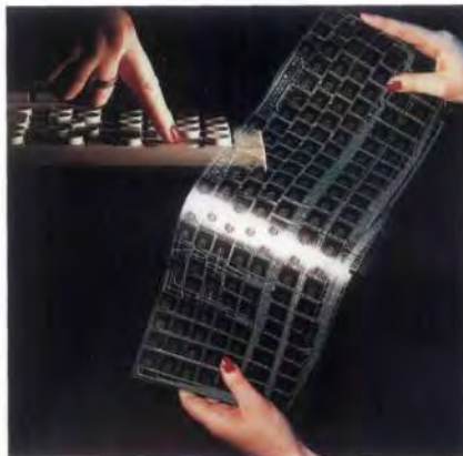
Folienschalter in Multilayer-Technik mit gedruckten Kondensatoren.
