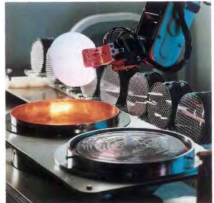
Vollautomatische Glaspassivierung mit Reinraum-Roboter.
