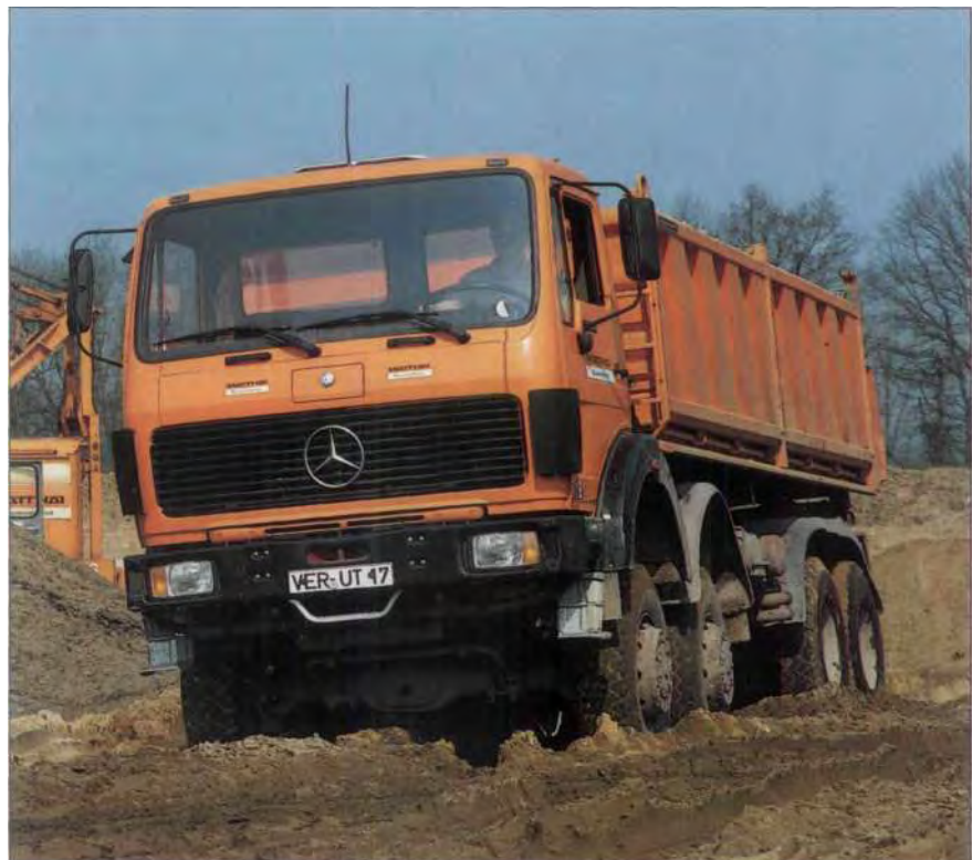
Das Vierachser-Lastwagenprogramm umfaßt Fahrgestelle für Gesamtgewichte von 32 bis 48t mit Motorleistungen von 206 bis 261 kW (280 bis 354 PS) und variablen Radständen von 4,10 bis 6,50 m.
