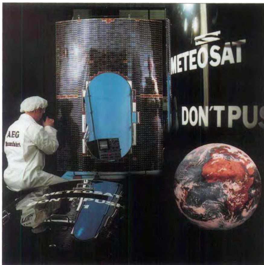
Vermessung eines Strukturpanels für den Wettersatelliten METEOSAT in Wedel bei Hamburg, für den die AEG den kompletten Solargenerator baut. Im METEOSAT wurden etwa 33.000 Solarzellen in der Größe von 19,8 x 39,6 mm verarbeitet.
