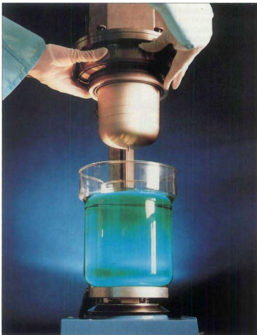
Vernickeln eines Kollektors einer Hochleistungs-Satelliten-Wanderfeldröhre von AEG. Wanderfeldröhren sind die Schlüsselkomponenten für die hohe Sendeleistung der Satelliten, die bis zu 260 W reicht.
