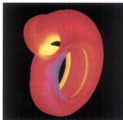
Keramische Turbinenspirale: Bei Forschungsarbeiten an Fahrzeug-Gasturbinen werden für die heißgasführenden Bauteile keramische Werkstoffe verwendet. Bei Temperaturen bis zu 1.300 °C treten hohe Wärmespannungen auf. Die Abbildung zeigt die mit Hilfe der Computersimulation ermittelte Temperaturverteilung in einer Turbinenspirale.
