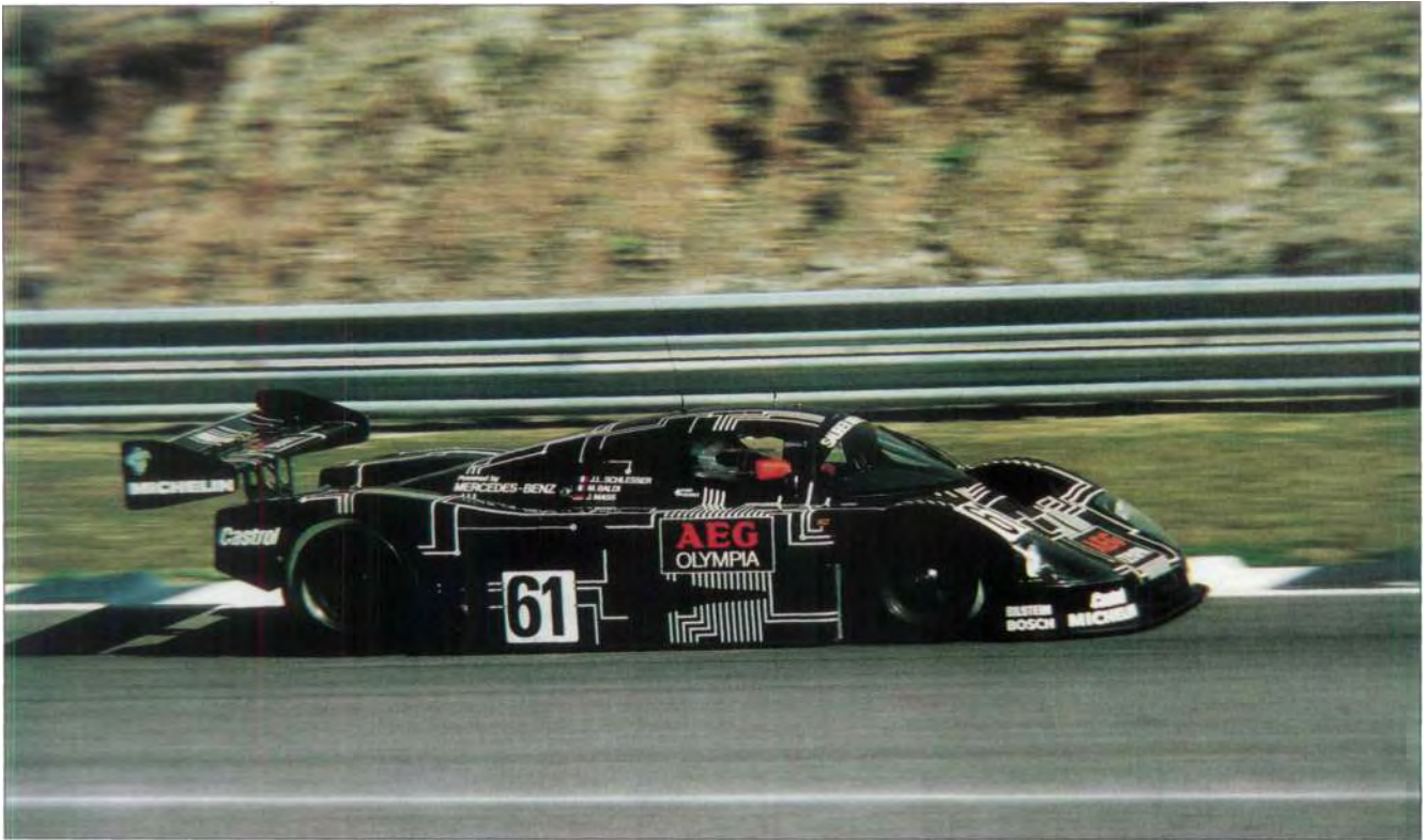
Der Sauber-Mercedes C 9 beendete das erste Rennen der Saison 1988 Jerez (Spanien) als Sieger. Der Gruppe C-Rennwagen hat einen 800 PS starken Mercedes-Fünfliter-Achtzylindermotor.
