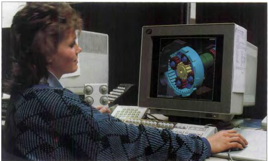
Kinematische Simulation eines Planetengetriebes mit dem CAD/CAM-System CATIA.
