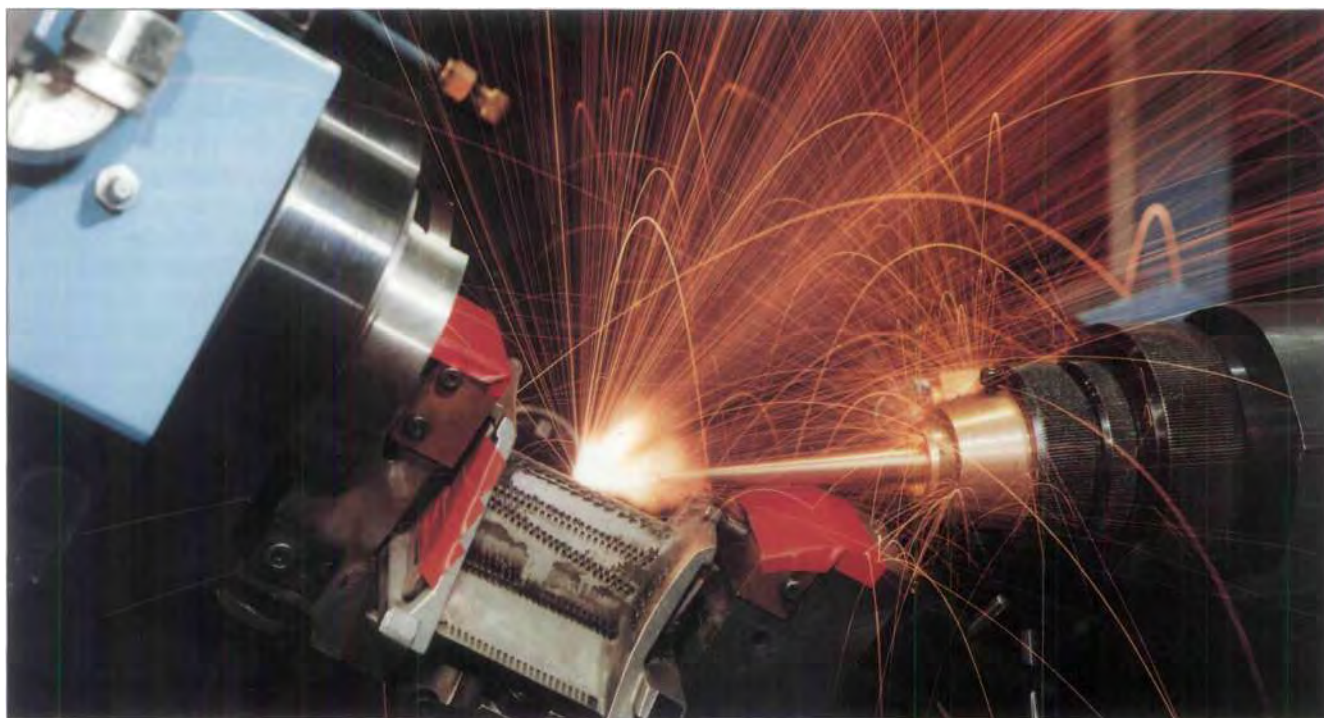
Bohren von Kühlluftöffnungen in einer hochwarmfesten Turbinenschaufel mit Hilfe eines Laserstrahls.
