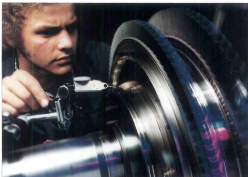
Prüfung des Rundlaufs der Labyrinthdichtungsstege an einem Turbinenidufer.
