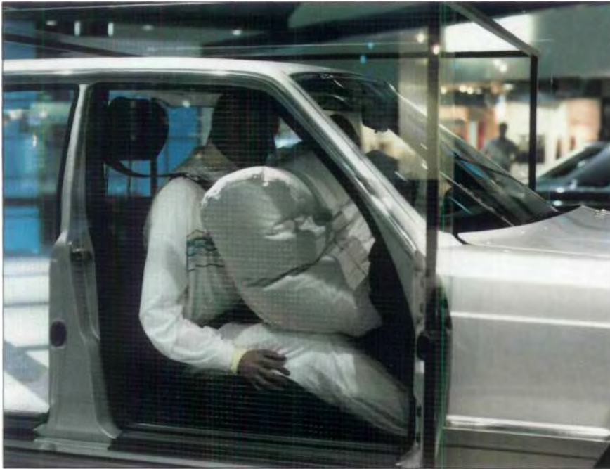
Seit Ende 1980 wird als zusätzliches Rückhaltesystem für den Fahrer der Airbag im Lenkrad angeboten - mehr als 400.000 Mercedes-Personenwagen wurden inzwischen damit ausgerüstet. Mit dem Airbag für den Beifahrer in Verbindung mit den serienmäßigen Gurtstraffern bietet Daimler-Benz eine umfassende Technik zur Verminderung des Verletzungsrisikos bei schweren Frontalzusammenstößen.
