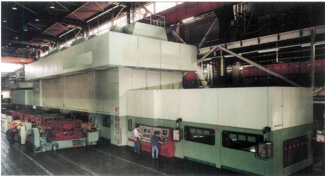
Beschaffung aus dem Investitionsgüterbereich: Hochmoderne Großteilstufenpresse im Werk Bremen, die gemeinsam mit einem Spezialisten der Anlagenindustrie entwickelt wurde.
