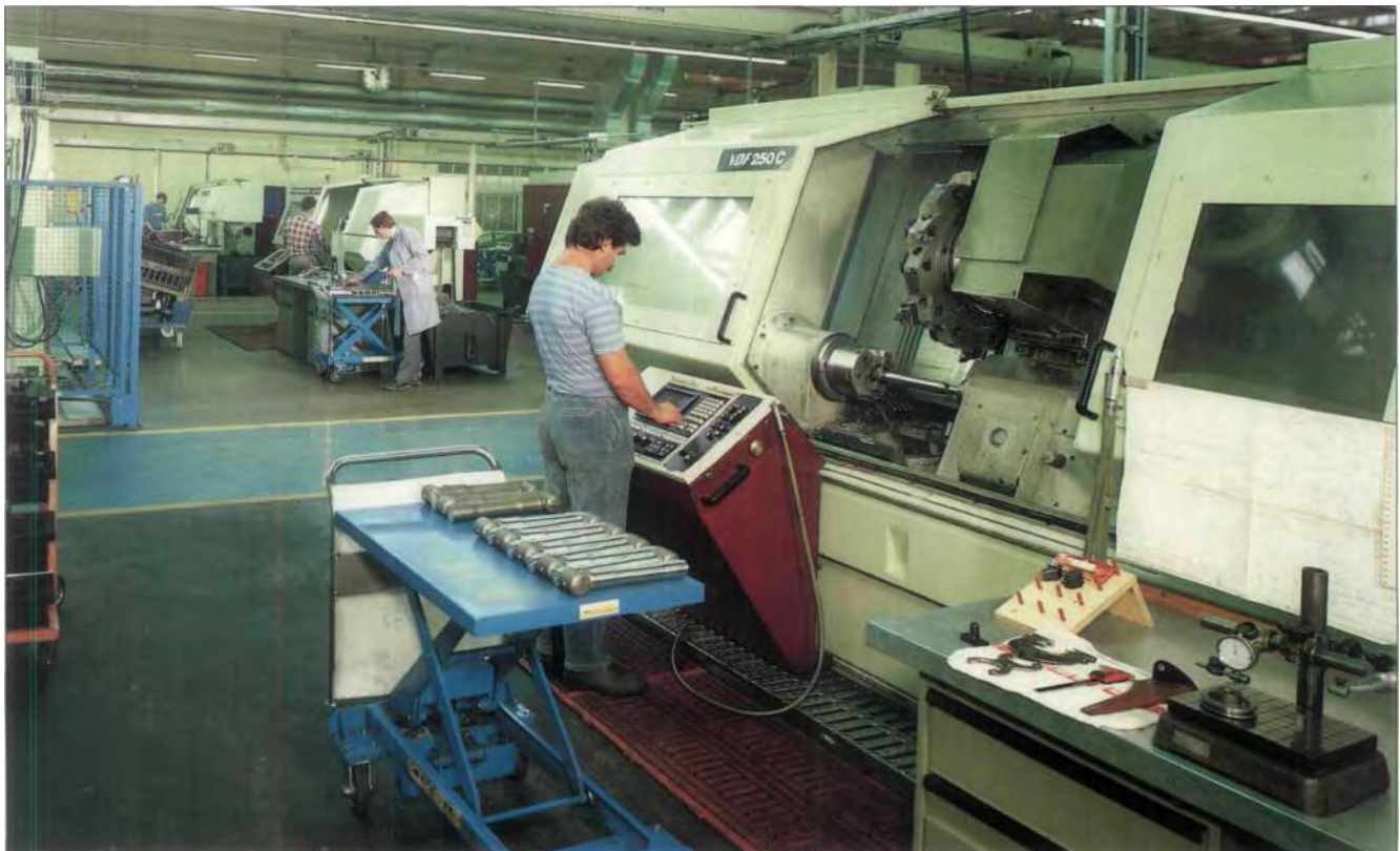
DNC-Dreherei im Werk Berlin zur Herstellung unterschiedlicher Serien-, Vorserien- und Versuchsteile. 21 CNC-Drehmaschinen, ein Werkzeugvoreinstellgerät sowie eine Meßmaschine sind über ein Rechnernetzsystem gekoppelt. Aufgaben, die früher der Planung vorbehalten waren, werden jetzt vor Ort von hochqualifizierten Mitarbeitern in der Fertigung selbst erledigt.
