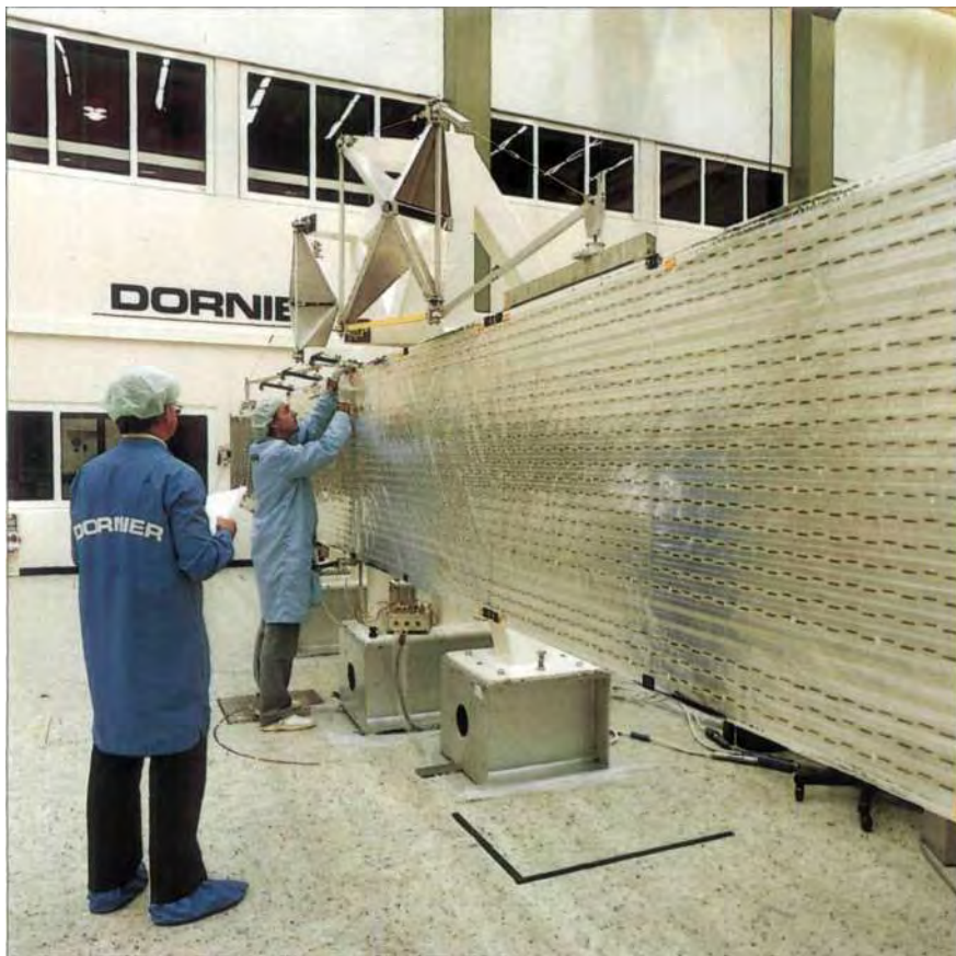
Die aus kohlefaserverstärktem Kunststoff hergestellte SAR-Antenne (Synthetic-Aperture-Radar) des europäischen Erdkundungssatelliten ERS-1.
