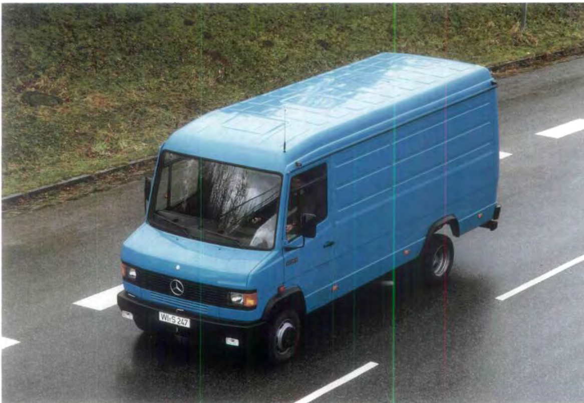
Die neue Transporter-Baureihe T 2 basiert auf dem technischen Konzept der leichten Wörther Lkw; die Typenpalette reicht von 4,6 bis 7,5t zulässiges Gesamtgewicht und umfaßt auch abgetastete Varianten.
