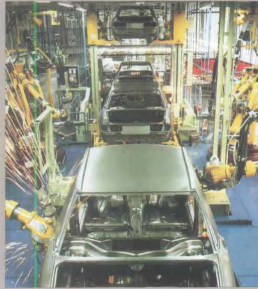
Industrieroboter sichern im Robbau gleichbleibend hohe Präzision und entlasten den Menschen.
