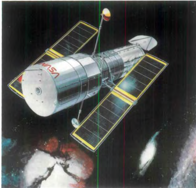
Weltraum-Teleskop der NASA mit einem von der AEG hergestellten ausrollbaren Solargenerator, der eine Leistung von 4 kW hat.
