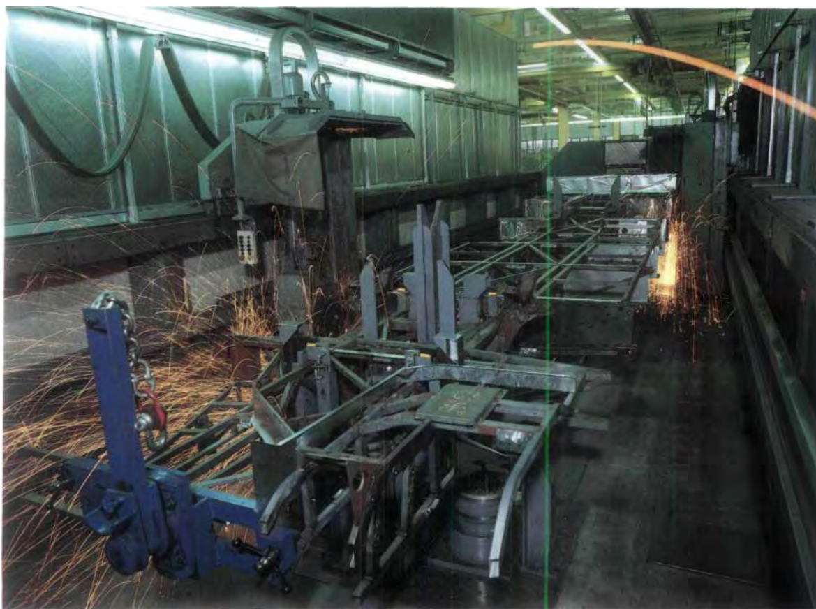
Maßgenauigkeit ist ein Gütezeichen bei der Fertigung von Mercedes-Benz-Omnibussen. Im Bild: Besäumanlage für Omnibus-Unterbauten im Werk Mannheim.
