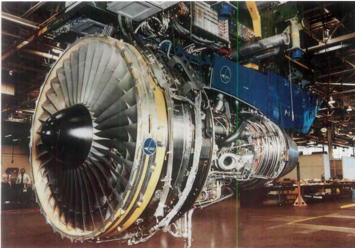
Das Turbofantriebwerk PW 2037 - von der MTU in Kooperation mit Pratt & Whitney verwirklicht - brachte im Bereich ziviler Großtriebwerke für die MTU erstmals die eigenverantwortliche Entwicklung und Fertigung eines kompletten Moduls, der Niederdruckturbine.
