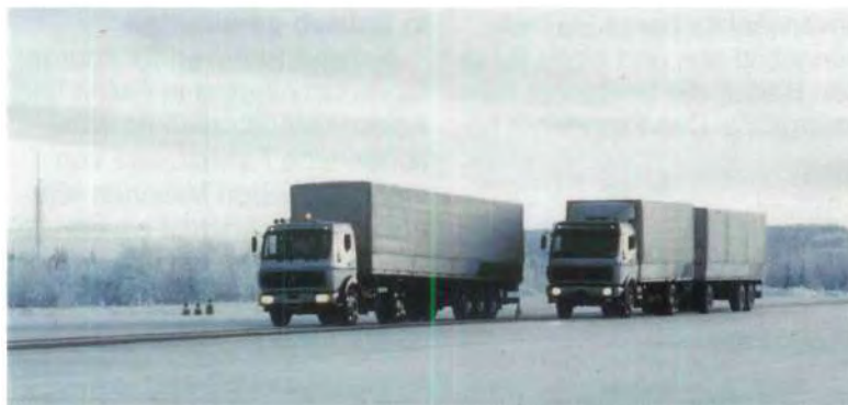
Antriebs-Schlupf-Regelung (ASR) verbessert die Fahrstabilität von Nutzfahrzeugen. Bei schwierigen Straßenverhältnissen wird bei einer Slalomfahrt deutlich: das rechte Fahrzeug (ohne ASR) bricht aus und dreht sich, mit ASR (links) wird die Slalomstrecke gefahrlos passiert
