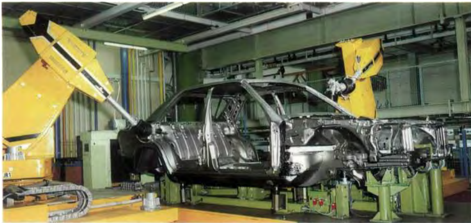
Typflexible Rohbau-Karosseriemeßstation mit zwei achtsichtigen Industrierobotern prüft an rund 500 Meßpunkten pro Karosserie die Einhaltung vorgegebener Toleranzwerte.
