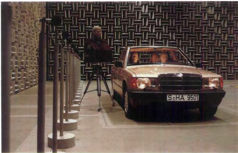
Bisher weltweit einmaliges Verfahren zur isolierten Messung von Außengeräuschen. Der Daimler-Benz-Prüfstand - entwickelt in Zusammenarbeit mit der TH Aachen - erlaubt die objektive Vergleichbarkeit von Geräuschen und damit die gezielte Reduzierung erkannter Geräuschquellen.
