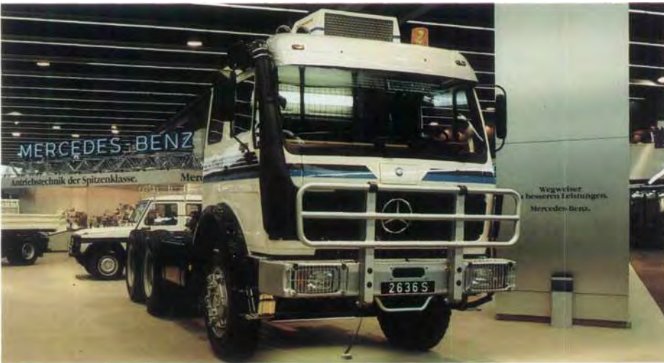
Für weltweiten Einsatz entwickelt: Mercedes-Benz 2636 S/6 x 4. Fernverkehrs-Sattelschlepper mit dem neuen 261 kW (355 PS) Saugmotor.
