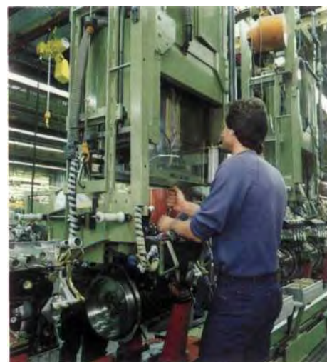
Präzisionsarbeit bei der Einstellung des Ventilspiels an den 190/190 E-Motoren im Werk Untertürkheim.
