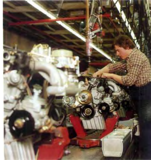
Fertigung der neuen Pkw-4-Zylinder-Benzinmotoren in Untertürkheim - ergonomisch günstig an kippbaren Werkstücken.
