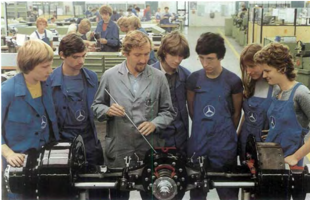
Ausbildung am realen Objekt im Achsenwerk Kassel. Schnittmodell einer Lkw-Hinterachse.
