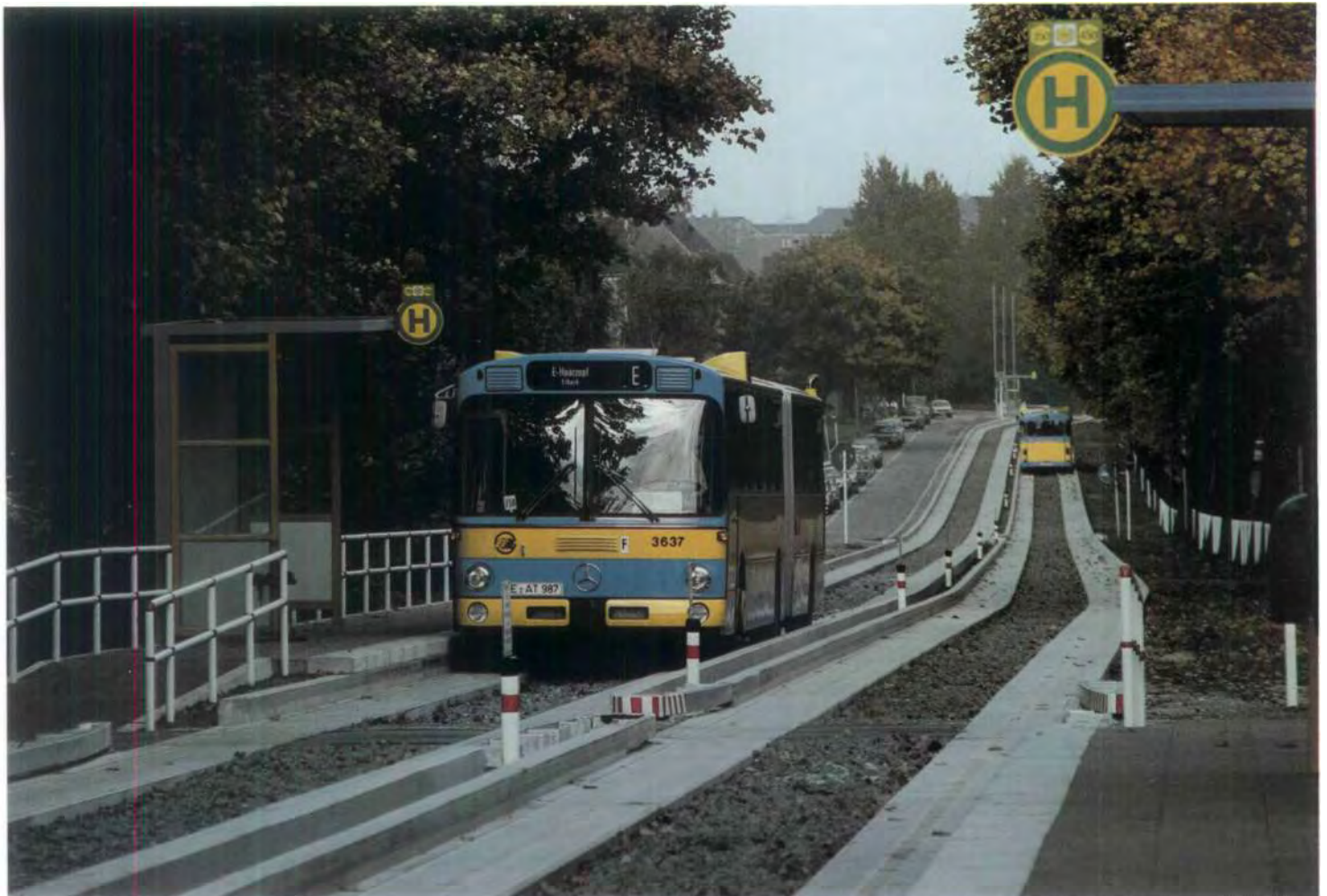
In Essen wurde die erste Mercedes-Benz-Spurbus-Verkehrslinie eröffnet. 21 Mercedes-Benz-Schubgelenkbusse O 305 G sind im Einsatz.
