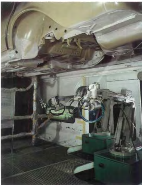
Entlastung von schwerer körperlicher Arbeit. Im Pkw-Werk Sindelfingen spritzen Industrieroboter den PVC-Unterbodenschutz.
