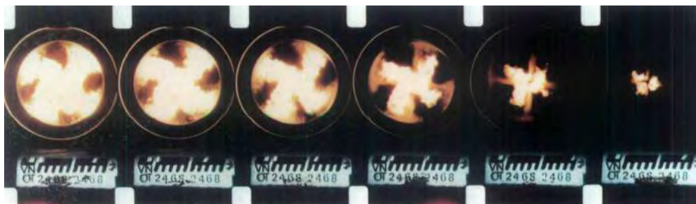
Untersuchungen von Gemischbildung, Flamm-entwicklung und Luffterfassung im Dieselmotor mit Hilfe der Hochgeschwindigkeitsfotografie.
