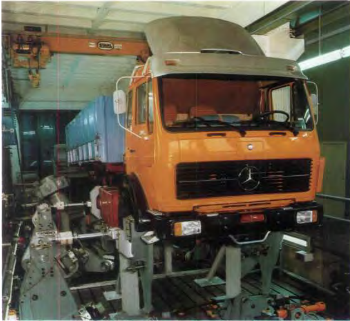
Der rechnergesteuerte Rüttelprüfstand für Nutzfahrzeuge erspart Dauerfahrten auf Prüfstrecken.
