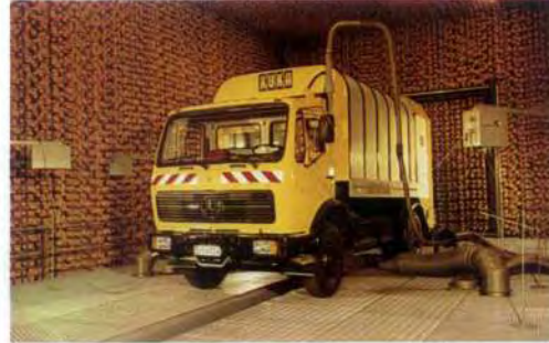
Kommunalfahrzeug im neuen Geräuschprüfstand (links). Elektronische Meß- und Aufzeichnungsanlage für Geräuschprüfungen (unten).
